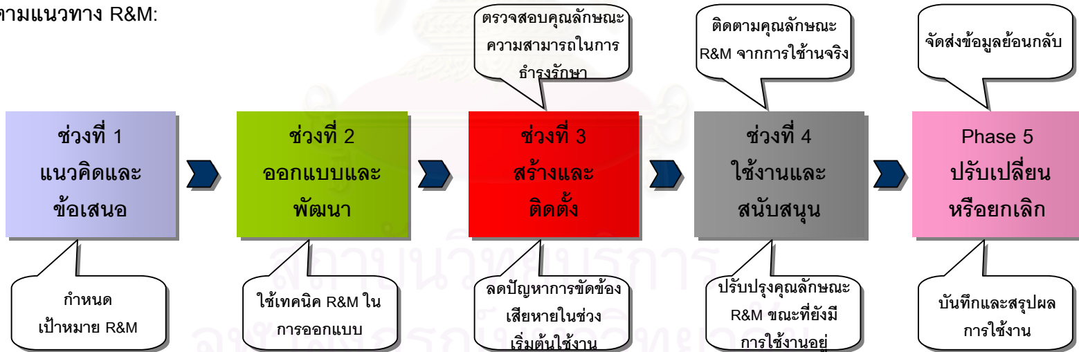
รูปที่ 4.7 เปรียบเทียบลักษณะการดำเนินงานระหว่างระบบปัจจุบันกับระบบตามแนวทาง R&M
