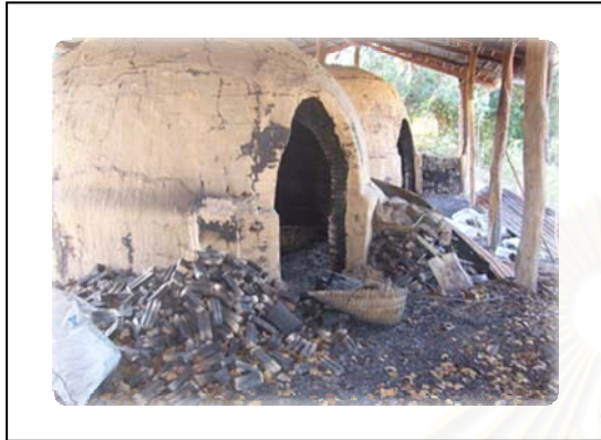
ภาพ 3.11 เตาเผาถ่านเพื่อการพาณิชย์ แบบเตาโดม ของคุณนำพล ที่ อ.เกษตรวิสัย จ.ร้อยเอ็ด ได้รับการสนับสนุนจากกรมป่าไม้
