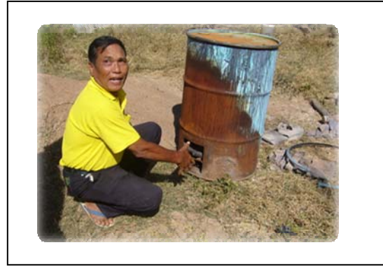
ภาพ 3.1-3.2 วิชยากรท้องถิ่น จ.นครราชสีมา กำลังแสดงให้เห็นความแตกต่างระหว่างเตาเผาถ่านแบบถัง 200 ลิตรแบบเดิม กับแบบที่ประยุกต์ขึ้นมาใหม่เพื่อให้ติดตั้งและเคลื่อนย้ายได้ง่าย
