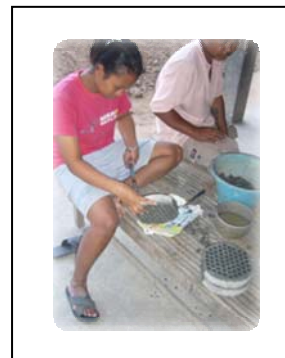
ภาพ 3.15-3.16 การปั้นเตาหุงต้มประสิทธิภาพสูงที่บ้านคุณบุญชู ฉ่ำชื่นใจ ตำบลตระแสง จ.สุรินทร์ จะเห็นได้ว่าการเจาะรังผึ้งยังต้องใช้แรงงานคนเป็นหลัก
