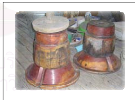
ภาพ 3.19-3.20 เตาหุงต้มประสิทธิภาพสูงหลายขนาด หลายแบบ และแบบพิมพ์สำหรับเตาหุงต้มประสิทธิภาพสูง ของคุณนำพล จ.ร้อยเอ็ด
