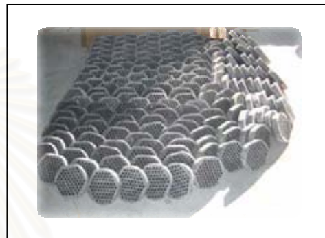
ภาพ 3.17-3.18 พิมพ์สำหรับทำรังผึ้งของเตาหุงต้มประสิทธิภาพสูง ของคุณนำพล จ.ร้อยเอ็ด
