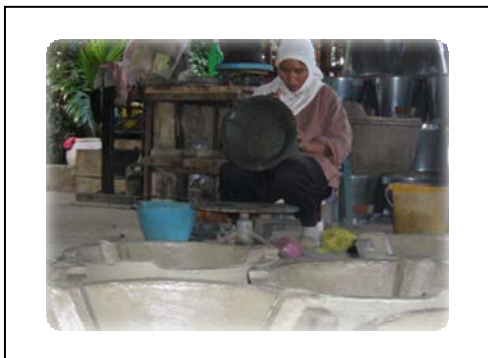
ภาพ 3.15-3.16 การปั้นเตาหุงต้มประสิทธิภาพสูงที่บ้านคุณบุญชู ฉ่ำชื่นใจ ตำบลตระแสง จ.สุรินทร์ จะเห็นได้ว่าการเจาะรังผึ้งยังต้องใช้แรงงานคนเป็นหลัก
