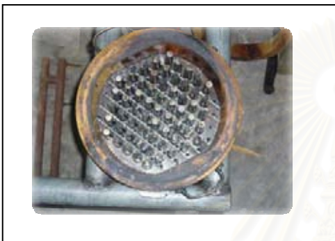
ภาพ 3.17-3.18 พิมพ์สำหรับทำรังผึ้งของเตาหุงต้มประสิทธิภาพสูง ของคุณนำพล จ.ร้อยเอ็ด
