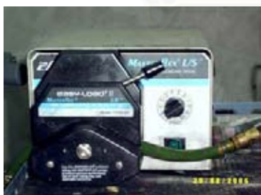
รูปที่ 3.3 เพอริสแตติกปั๊ม (Peristaltic pump)
