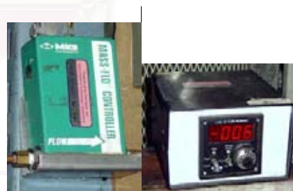
รูป 3.4 เครื่องวัดและปรับอัตราการไหล ของแก๊ส (Mass flow meter and controller)
