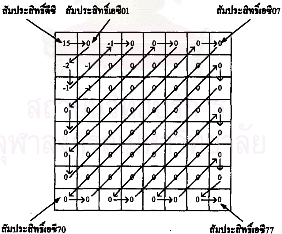
รูปที่ 2.23 แสดงการเข้ารหัสรันแลนทด้วยลำดับแบบซิกแซก (Fluckiger, 1995)
