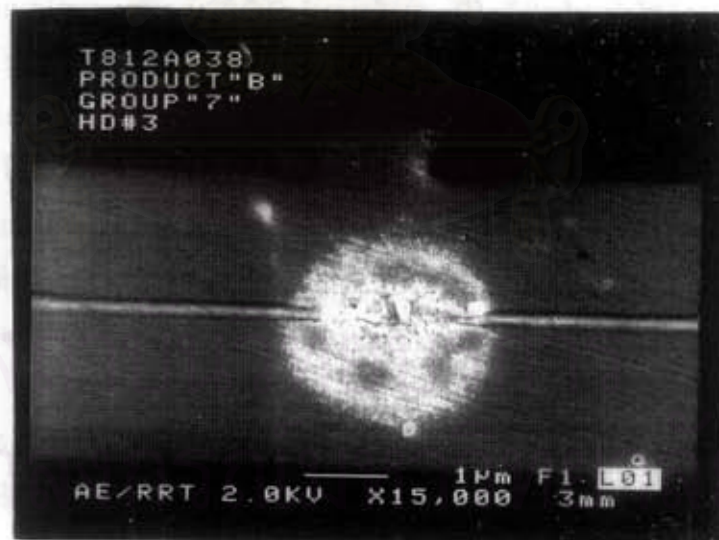
รูปที่ 6.14 แสดงภาพถ่ายบริเวณแมกนีโทริซิสทีฟของหัวอ่านเขียนแมกนีโทริซิสทีฟแบบ B ด้วย FE-SEM ที่กำลังขยาย 150,000 เท่า หลังจากผ่านการทดสอบ Accelerated Electro-Migration ที่ อุณหภูมิ 60 °C และกระแสไฟฟ้าตรง 16 มิลลิแอมป์ เป็นเวลา 428 ชั่วโมง ที่มา : ห้องปฏิบัติการของโรงงานตัวอย่าง
