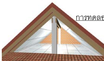
หลังคาปูฉนวนทั้ง 2 ชั้นปิดพัดลม (Roof insulate+alu without fan) composite
