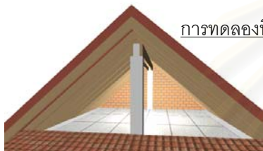
หลังคาปูฉนวนฝ้าเพดานปิดพัดลม (Roof insulation without fan) conduction
