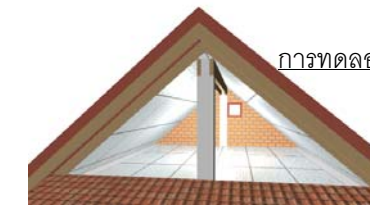
หลังคาปูฉนวนทั้ง 2 ชั้นเปิดพัดลม (Roof insulate+alu with fan)
