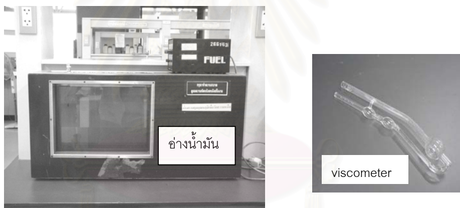
รูปที่ 3.7 เครื่องวิเคราะห์ความหนืด (อ่างน้ำมัน และ Viscometer)
