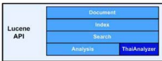
รูปที่ 4.1 โครงสร้างทางสถาปัตยกรรมของลูซีน (Lucene API) [19]
