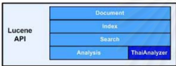
รูปที่ 5 โครงสร้างทางสถาปัตยกรรมของลูซีน (Lucene API) [11]
