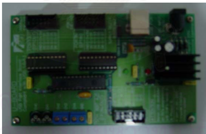
รูปที่ 2.17 Interface board ยี่ห้อ Inex รุ่น U-Board 1.0/1.1
