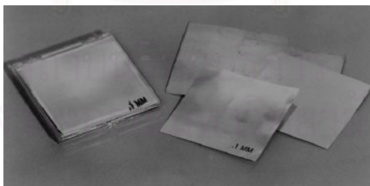
รูปที่ 2.11 แผ่นอะลูมิเนียมมาตรฐานบริสุทธิ์ 99.9 % เพื่อใช้วัดค่า HVL
