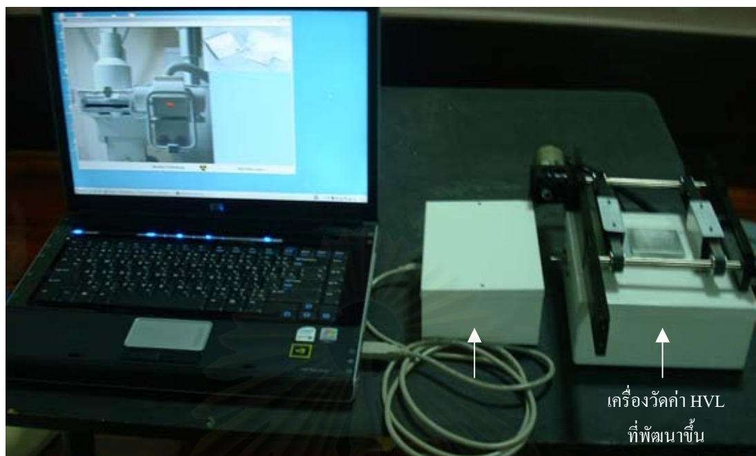
รูปที่ 3.14 แสดงการต่ออุปกรณ์วัดค่า HVL ที่พัฒนาขึ้น
