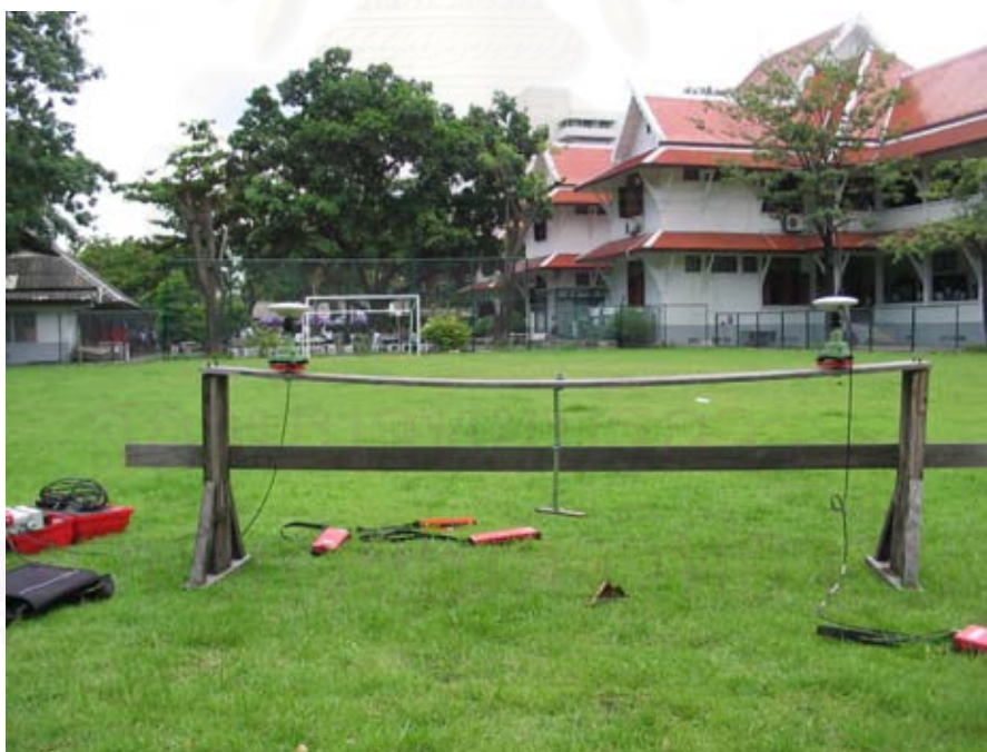
รูปที่ 3.2 แบบจำลองการเคลื่อนตัวทางดิ่งเพื่อทดสอบแบบเก่า
