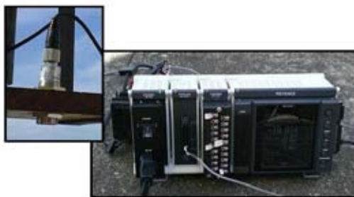
รูปที่ 3.1 เครื่องวัดระยะเลเซอร์ (Laser Displacement Sensors)
