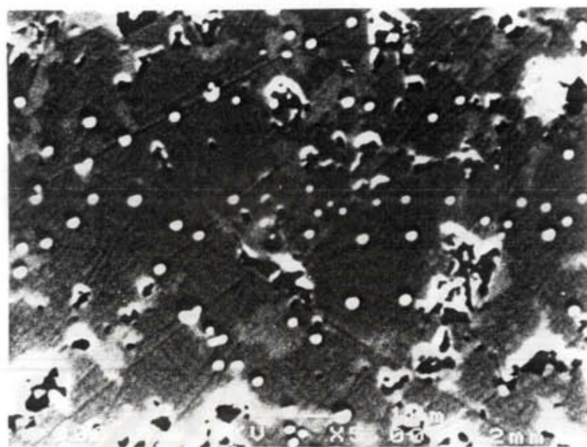
(ก) อุณหภูมิ/ความดัน/เวลา เท่ากับ 1550/1500/30
