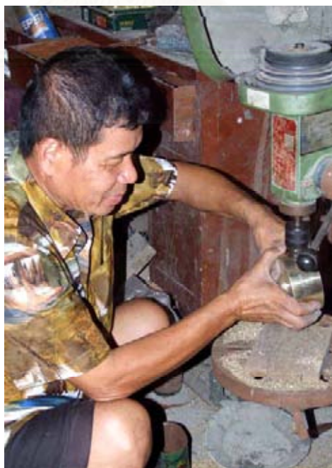
ภาพประกอบที่ 67 แสดงการนำลูกฆ้องหล่อที่วัดแล้วเข้าเครื่องเจาะ
