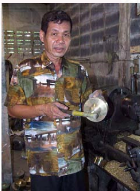
ภาพประกอบที่ 61 แสดงการเคาะลูกฆ้องหล่อเพื่อเตรียมเทียบเสียง
