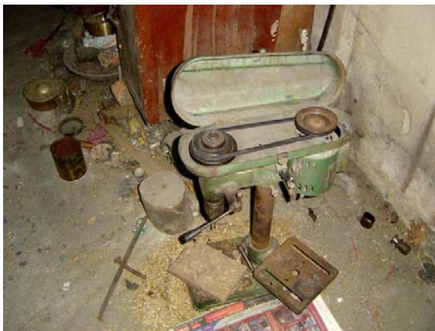
ภาพประกอบที่ 23 แสดงเครื่องเจาะที่ใช้สำหรับการเจาะลูกฆ้องหล่อ
