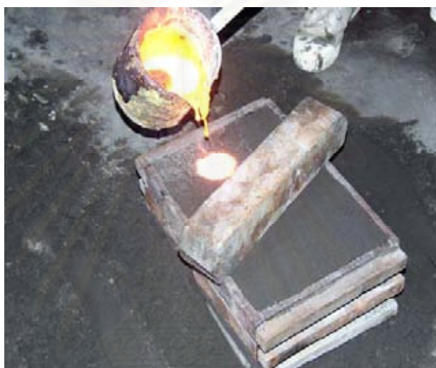
ภาพประกอบที่ 50 แสดงการเทโลหะใส่เบ้าหลอม
