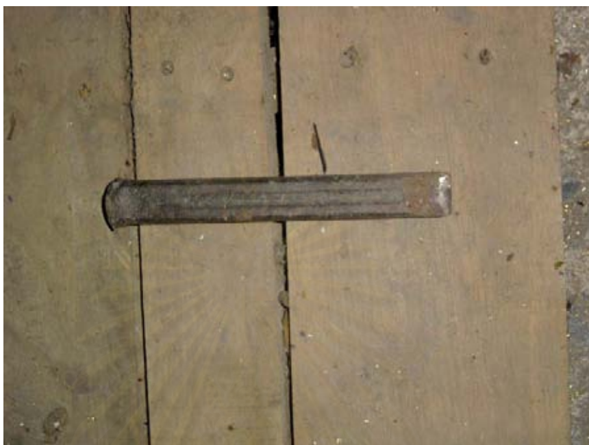
ภาพประกอบที่ 21 แสดงเครื่องมือที่เรียกว่าลิ่ว ใช้สำหรับขุดจี๋ผึ้ง
