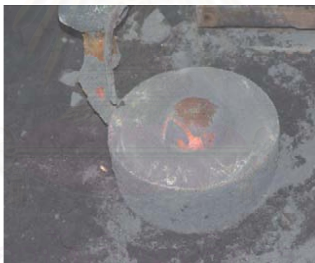
ภาพประกอบที่ 53 แสดงสภาพลูกหม่องที่ได้จากเบ้าหลอม(2)
