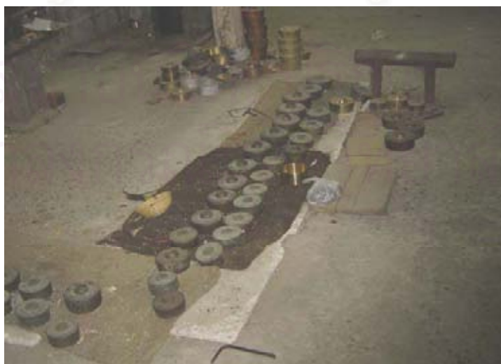
ภาพประกอบที่ 65 แสดงลูกฆ้องหล่อแม่แบบที่ใช้ในการเทียบเสียง
