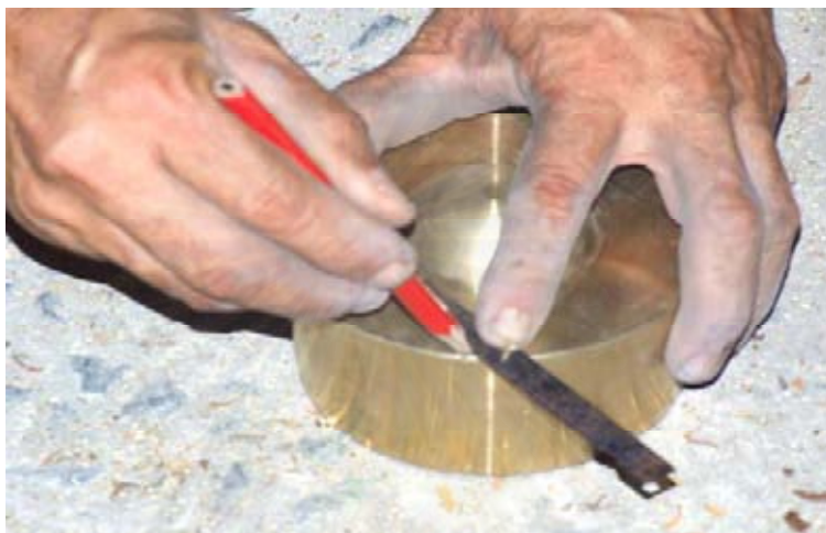
ภาพประกอบที่ 66 แสดงการวัดลูกฆ้องหล่อเพื่อหาจุดเจาะรูร้อยเชือก
