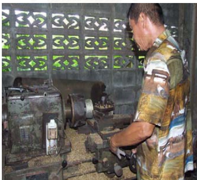
ภาพประกอบที่ 55 แสดงการกลึงลูกฆ้องหล่อ(1)
