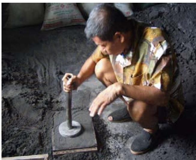
ภาพประกอบที่ 36 ของขั้นตอนการสร้างเบ้าหลอม(4)
