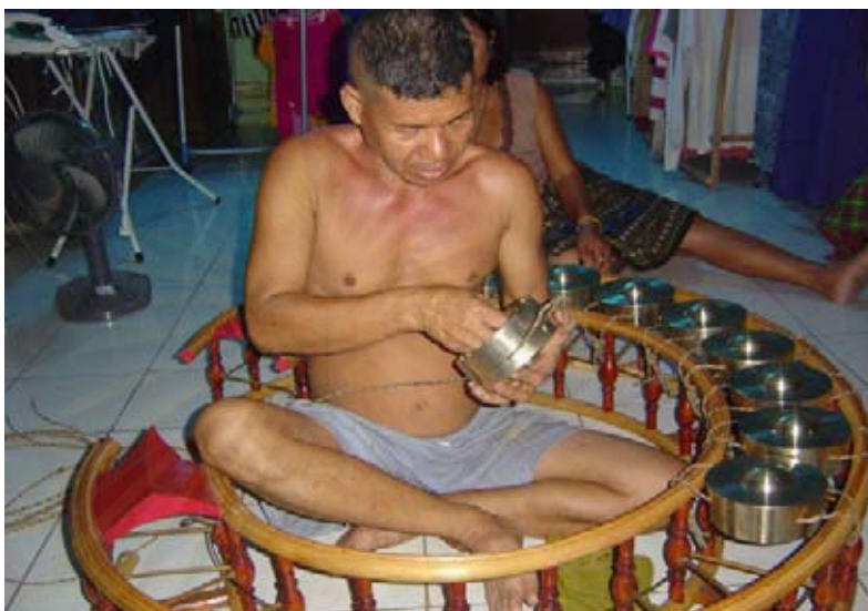
ภาพประกอบที่ 70 แสดงการร้อยเส้นหนังวัวเข้ากับลูกฆ้องหล่อ
