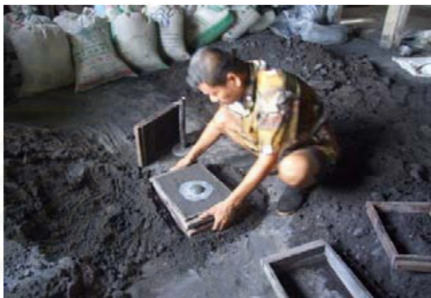
ภาพประกอบที่ 38 ขั้นตอนการสร้างเบ้าหลอม(6)
