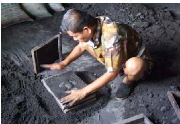
ภาพประกอบที่ 39 ขั้นตอนการสร้างเบ้าหลอม(7)
