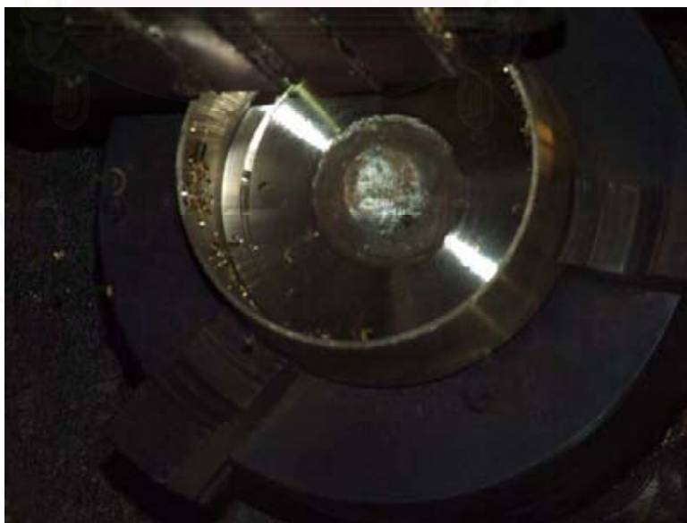
ภาพประกอบที่ 63 แสดงลูกห้องเมื่อกลึงด้านในเพื่อเทียบเสียง
