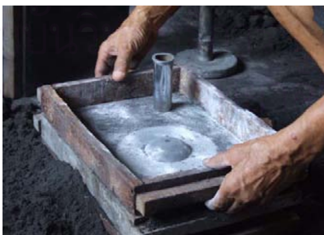
ภาพประกอบที่ 41 ขั้นตอนการสร้างเบ้าหลอม(9)
