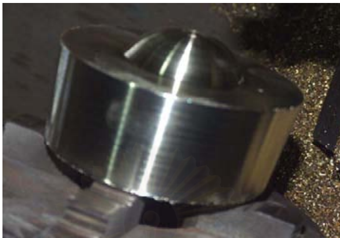
ภาพประกอบที่ 60 แสดงลูกฆ้องหล่อที่กลึงเสร็จเรียบร้อยแล้ว
