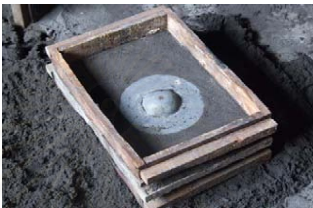
ภาพประกอบที่ 40 ขั้นตอนการสร้างเบ้าหลอม(8)
