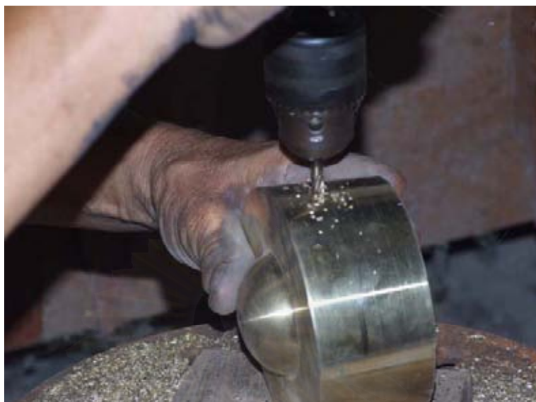
ภาพประกอบที่ 68 แสดงการเจาะลูกฆ้องหล่อในลักษณะแนวเฉียง
