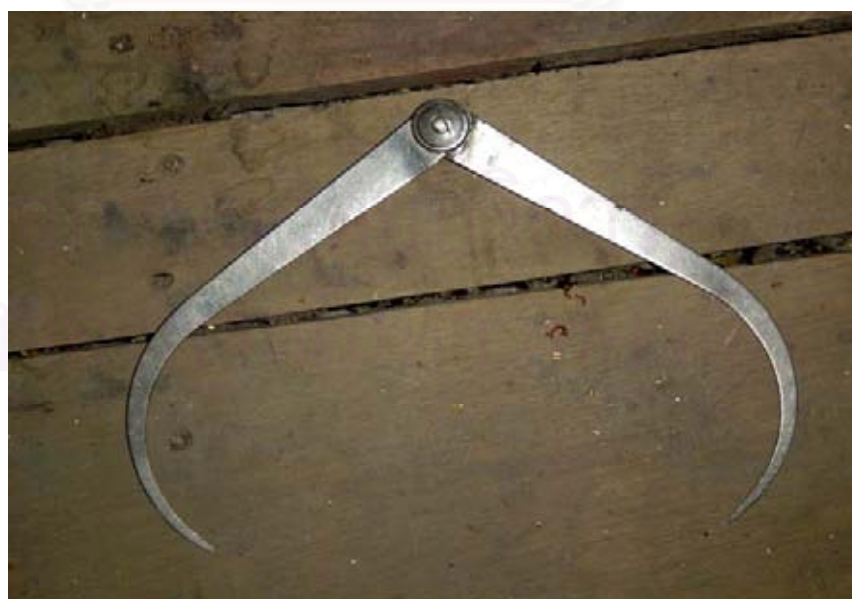
ภาพประกอบที่ 20 แสดงเครื่องมือที่เรียกว่าเขาควยใช้สำหรับวัดขนาดสัดส่วน
