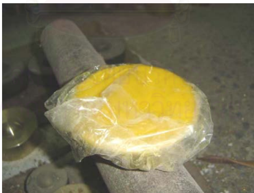
ภาพประกอบที่ 24 แสดงขี้ผึ้งที่ใช้เป็นส่วนผสมที่สำคัญในการใช้อุดลูกฆ้องหล่อ
