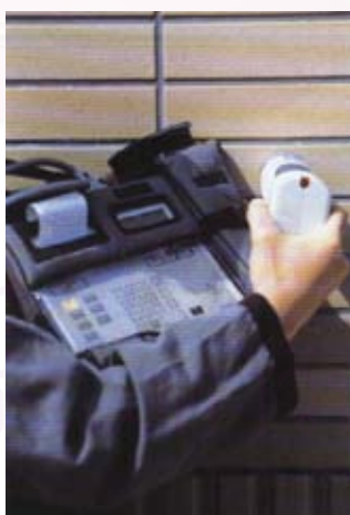
ภาพที่2.22 การเก็บข้อมูลสีด้วย Colorimeter 26
