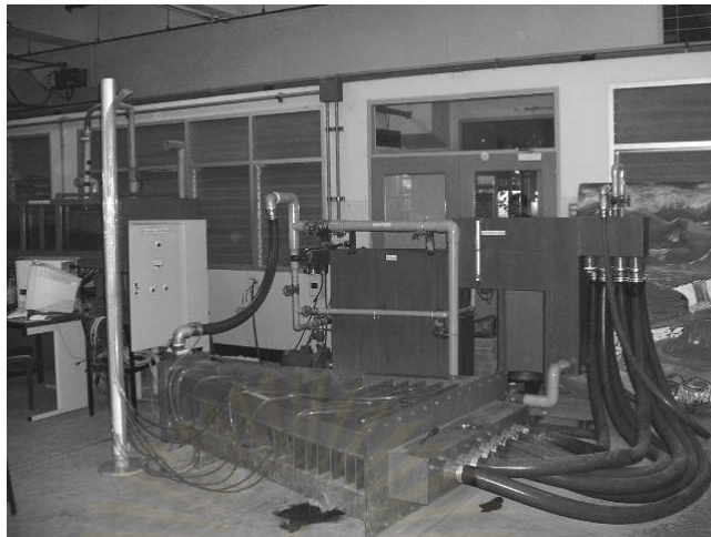
รูปที่ ง-7 ภาพรวมของเครื่องจำลองการสูบน้ำและอัดเติมน้ำภายใต้แรงดัน
