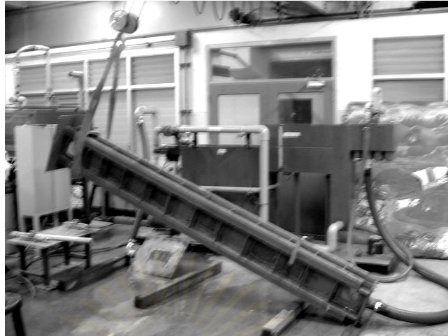
รูปที่ ง-23 การยกแบบจำลองขึ้นเพื่อใส่ทราย
