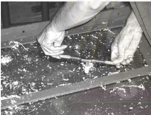
รูปที่ ง-4 การทำเกลียวที่แผ่นพลาสติกและการติดเซนเซอร์วัดความดัน
