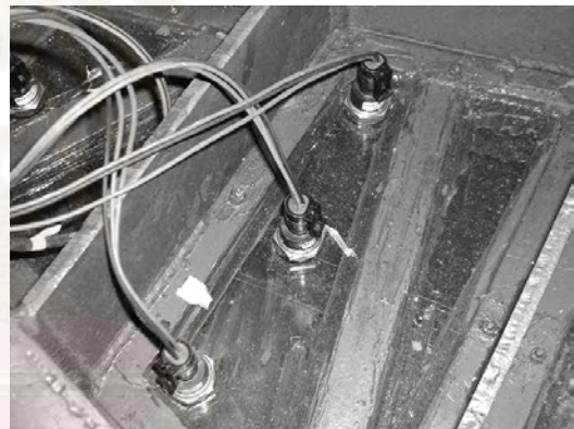
รูปที่ ง-4 การทำเกลียวที่แผ่นพลาสติกและการติดเซนเซอร์วัดความดัน
