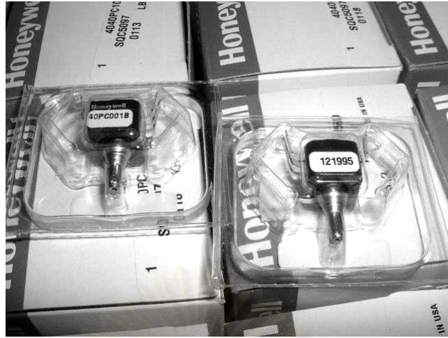
รูปที่ ง-14 เซนเซอร์วัดความดันสำหรับวัดระดับน้ำเหนือสันฝาย
