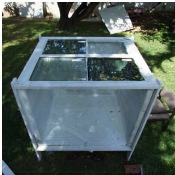
รูปที่ 3.25 แสดงโครงสร้าง พื้น และผนังของกล่องทดลอง
