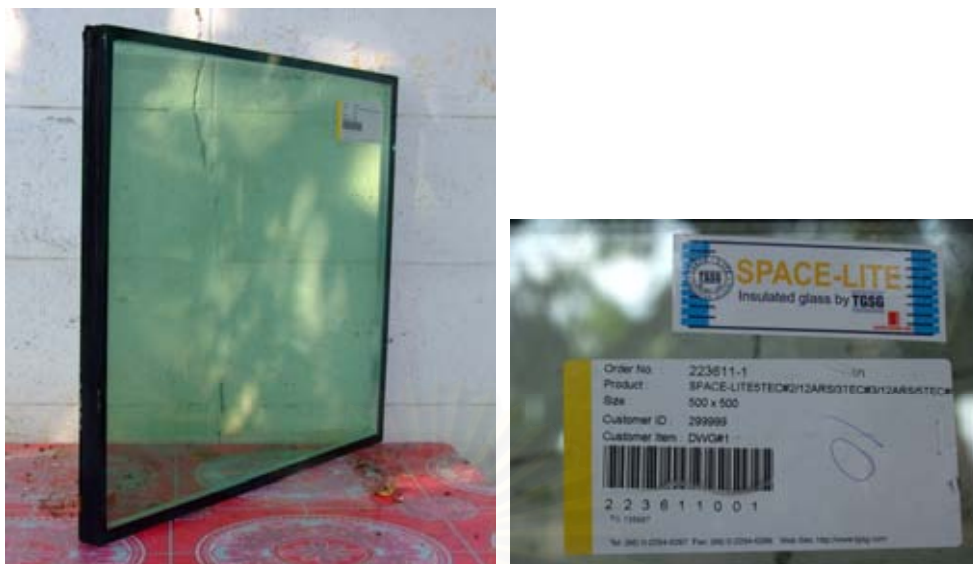
รูปที่ 3.13 กระจกฉนวนกันความร้อนช่องว่างอากาศ 1 ชั้น ความหนา 24.38 มิลลิเมตร รุ่น 24 Heat Stop SGLE50-RSCAZ
