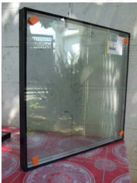
รูปที่ 3.14 กระจกฉนวนกันความร้อนช่องว่างอากาศ 2 ชั้น ความหนา 41 มิลลิเมตร รุ่น SPEC-LITE 5/14ARS/3TEC/14ARS/5TEC
