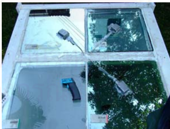
รูปที่ 3.22 แสดงตำแหน่งการวางอุปกรณ์วัดอุณหภูมิผิวกระจก
