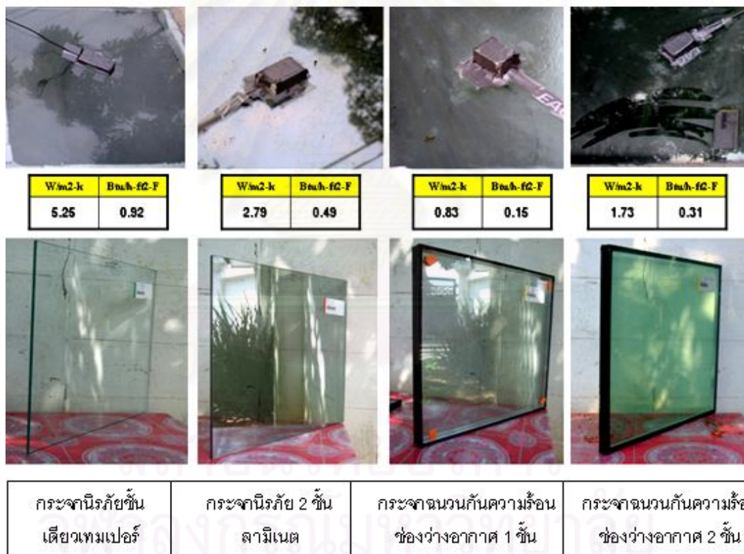
รูปภาพที่ 5.2 แสดงค่า U-VALUE ของกระจกทั้ง 4 ชนิดที่นำมาทดลอง โดยเป็นรายการคำนวณจากฝ่ายบริการเทคนิค บริษัท ไทย-เยอรมัน สเปเชียลตีกลาส จำกัด
