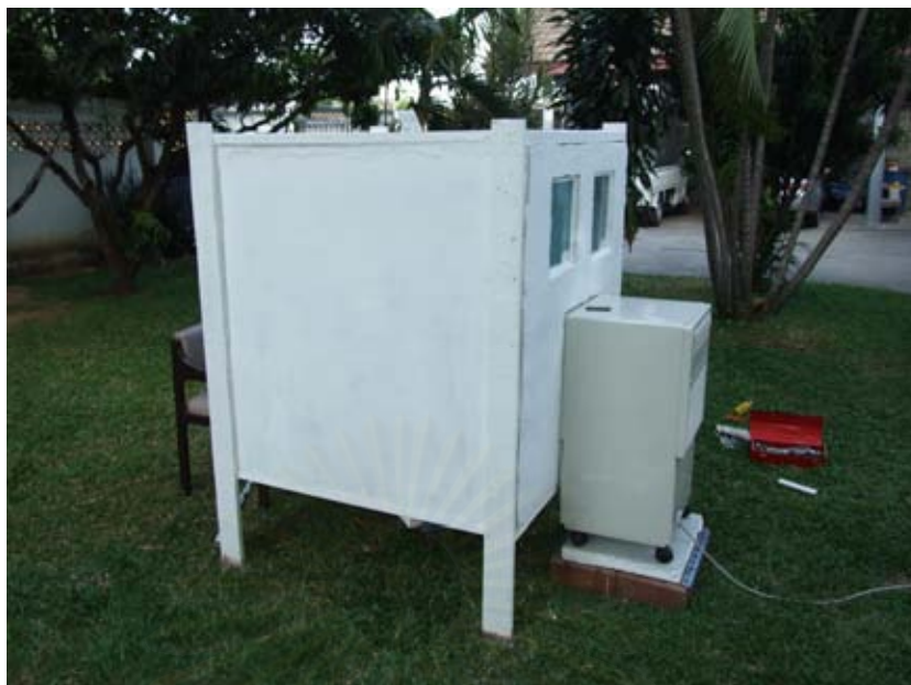
รูปที่ 3.7 แสดงการตรวจสอบอุณหภูมิภายในที่ 25 องศาเซลเซียส หลังจากที่เปิดระบบปรับอากาศ
