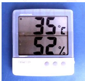
รูปที่ 3.4 เครื่องวัดอุณหภูมิและความชื้นสัมพัทธ์ Model DIGICON TH-03
