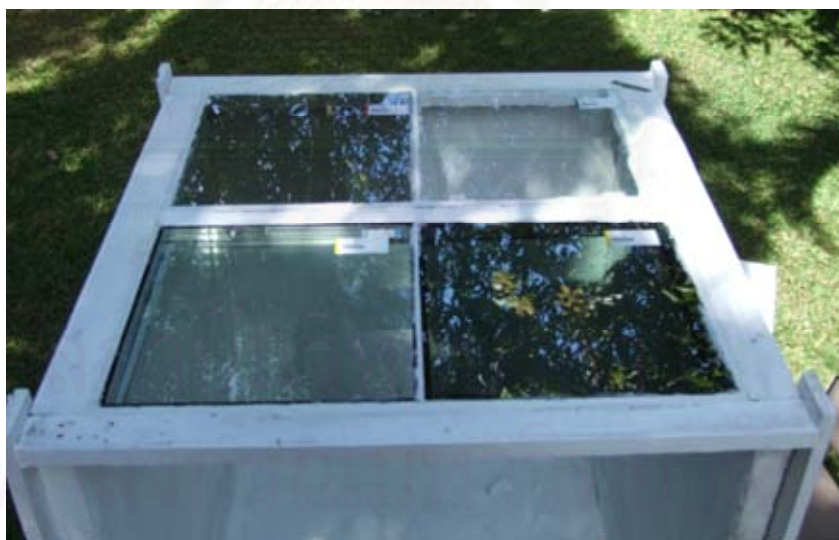
รูปที่ 3.8 แสดงการติดตั้งกระจกทดลองขนาด 50 x 50 เซนติเมตร จำนวน 4 แผ่น ที่ด้านบนของกล่องทดลองโดยทำมูมระนาบกับท้องฟ้า
