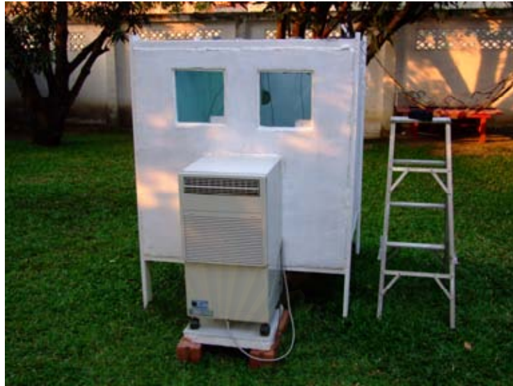
รูปที่ 3.15 แสดงการเจาะช่องเปิด 3 ช่องที่ผนังด้านทิศใต้
