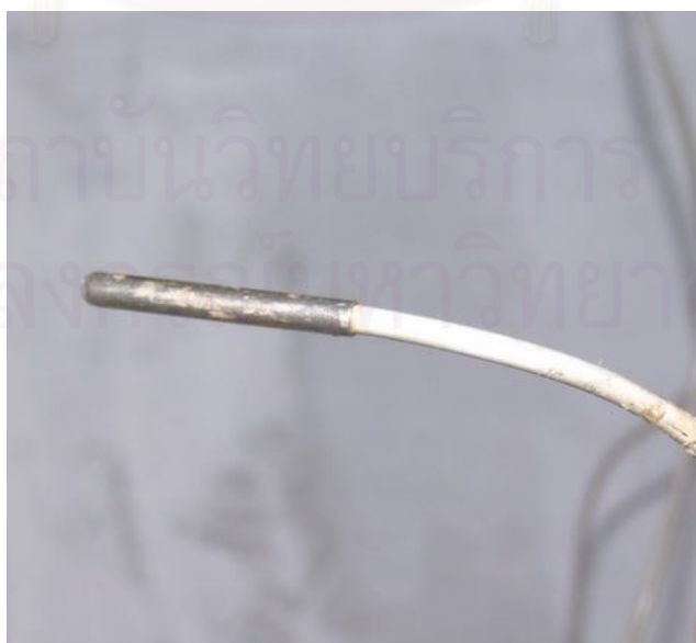
รูปที่ 3.5 หัววัดอุณหภูมิ Thermister
