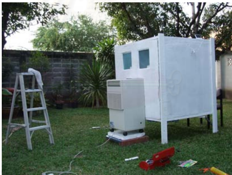
รูปที่ 3.6 แสดงการประกอบเครื่องปรับอากาศเข้ากับกล่องทดลอง
