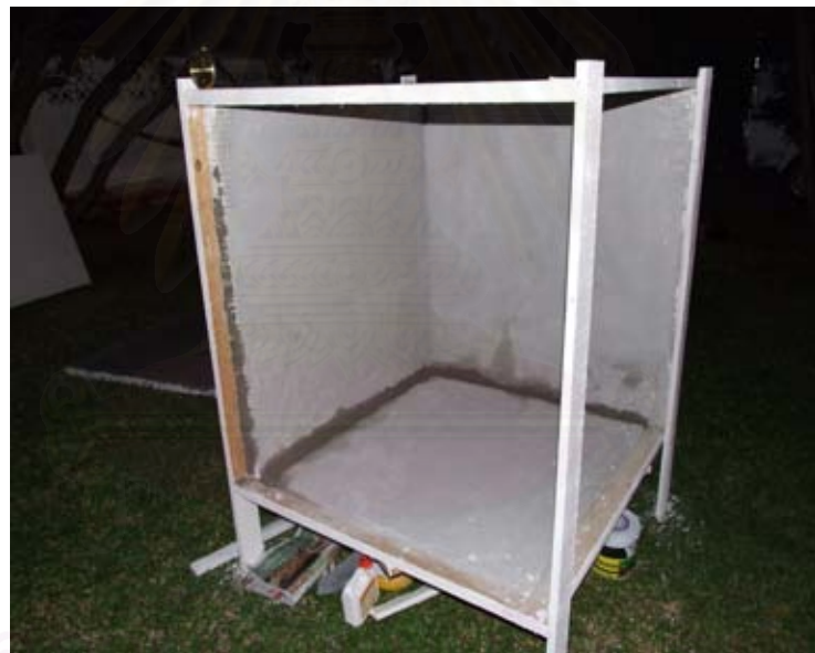
รูปที่ 3.16 การติดตั้งผนังทั้ง 4 ด้าน และพื้นกล่องทดลองที่ทำมาจากวัสดุที่มีคุณสมบัติความเป็นฉนวนเข้ากับ โครงสร้างกล่องทดลอง
