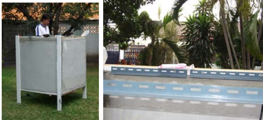
รูปที่ 3.19 แสดงการติดตั้งเฟรมรับกระจกด้านบนกล่องทดลอง
