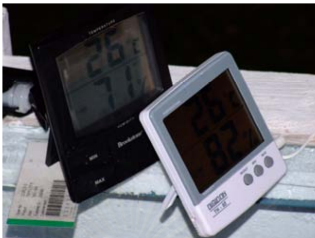
รูปที่ 3.23 แสดงเครื่องวัดอุณหภูมิอากาศและความชื้นสัมพัทธ์
