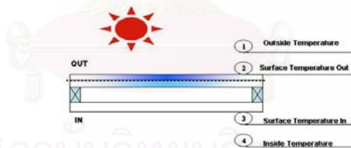
รูปที่ 3.32 แสดงลักษณะการเก็บข้อมูลอุณหภูมิของกระจก 24 Heat Stop SGLE50-RSCAZ
