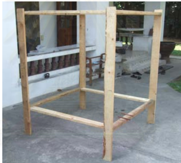
รูปที่ 3.29 แสดงรูปแบบโครงสร้างไม้ของกล่องทดลอง
