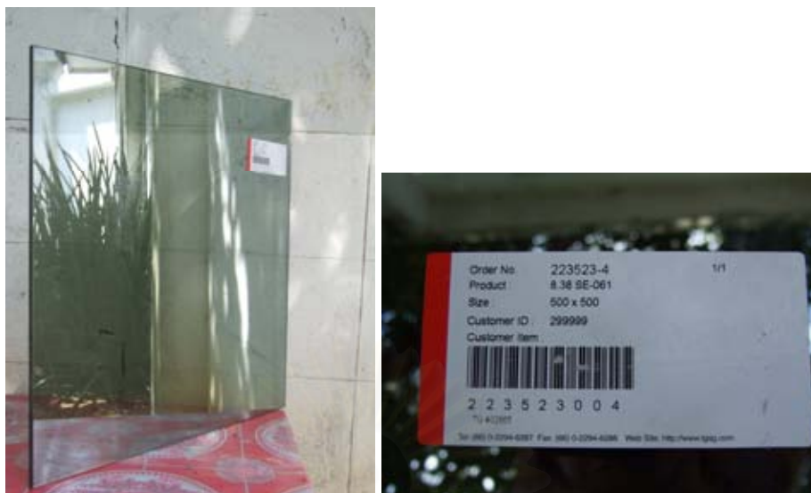
รูปที่ 3.11 กระจกนิรภัยหลายชั้น หรือกระจกลามิเนต Low-E (8.38 SE-061)
