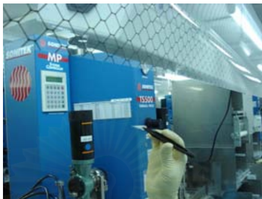
รูปที่ 4.16 ภาพแสดงการเป่าแผ่น Laminate ด้วย Ionizer Fan
