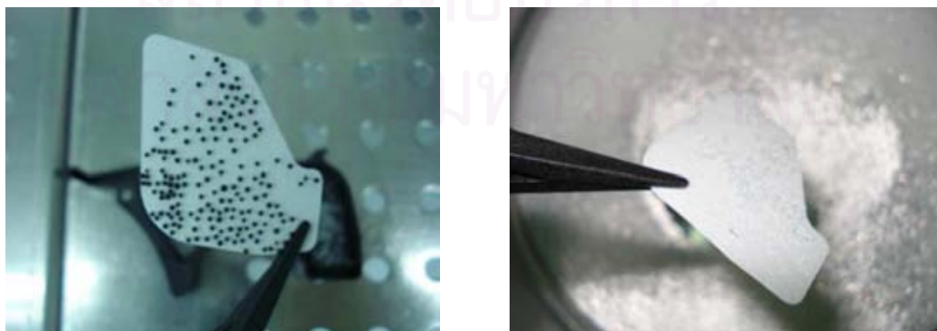
รูปที่ 3.28 เม็ดคาร์บอนและซิลิกาติดติดกับแผ่น Laminate เนื่องจากไฟฟ้าสถิต
