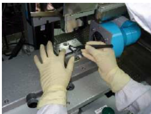
รูปที่ 3.57 ภาพแสดงการวางแผ่น Laminate ลงบน Housing
