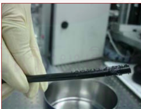
รูปที่ 3.43 ภาพแสดงการเกิดไฟฟ้าสถิตกับท่อทางเดิน
