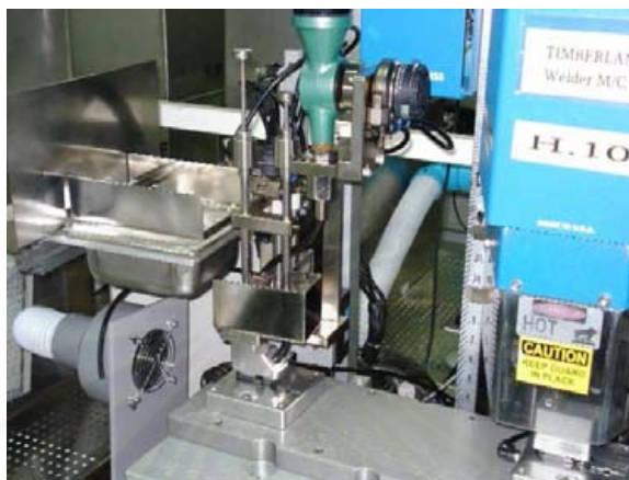
รูปที่ 4.10 ภาพแสดงช่วงหน่วงเวลาการป้อน Silica Gel และ Carbon Bead ลงใน Housing
