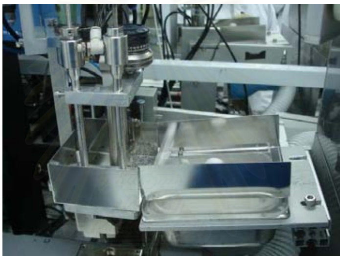
รูปที่ 4.2 ภาพการติดตั้งฝาครอบเพื่อป้องกันเม็ด Carbon Bead และ Silica Gel ตกกระจายลงมา
