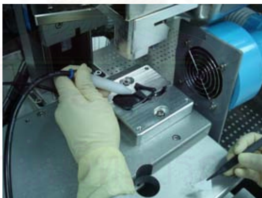
รูปที่ 4.17 ภาพแสดงการดูดเอา Carbon Bead และ Silica Gel ที่ติดตามรอยการเชื่อมออก
