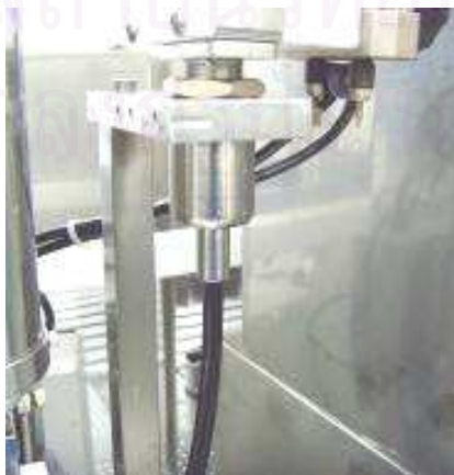
รูปที่ 3.41 ภาพแสดงการติดตั้งท่อส่งไม่เหมาะสมทำให้ Carbon Bead ติดค้างอยู่ด้านใน
