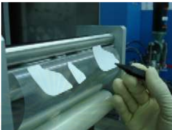
รูปที่ 4.14 ภาพแสดงการลอกแผ่น Laminate ออกมาจากม้วน
