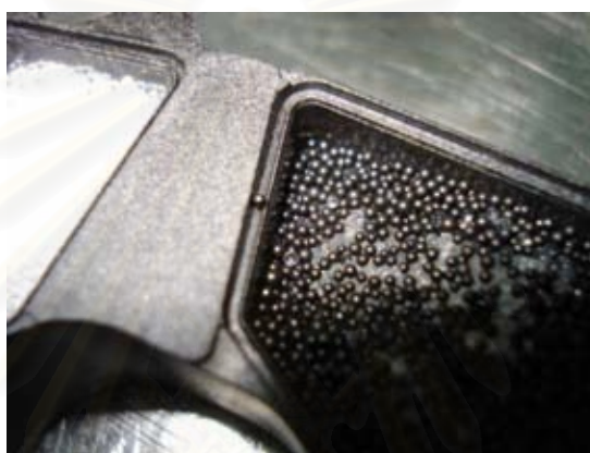
รูปที่ 3.27 เม็ดคาร์บอนกระเด็นขึ้นมาอยู่ตามแนวรอยการเชื่อม
