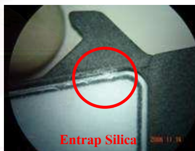
รูปที่ 3.23 ตัวอย่างของเสียของการตกค้างของคาร์บอนและซิลิกา
