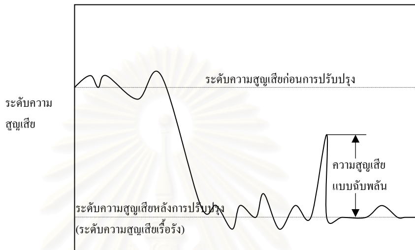
รูปที่ 1.1 รูปแบบการเกิดความสูญเสียและลักษณะความสูญเสียแบบเรื้อรัง
