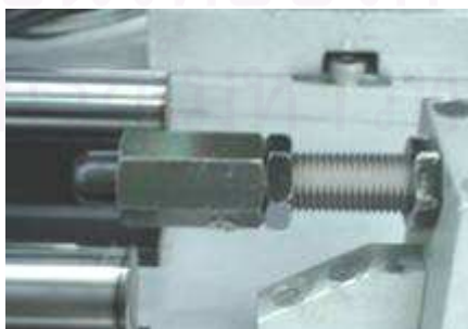
รูปที่ 3.65 ภาพ Stopper ที่ใช้ในปัจจุบัน
