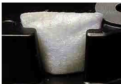
รูปที่ 3.2 แสดงส่วนประกอบของฮาร์ดดิสก์และหลักการทำงานของตัวกรองอากาศในฮาร์ดดิสก์
