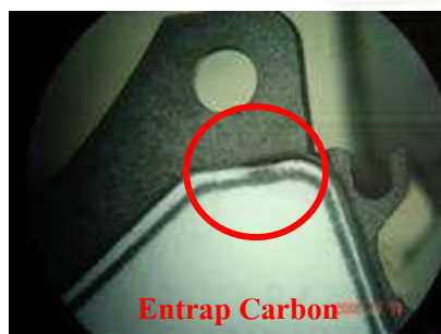
รูปที่ 3.23 ตัวอย่างของเสียของการตกค้างของคาร์บอนและซิลิกา
