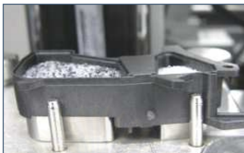
รูปที่ 4.7 ผลลัพธ์หลังการแก้ไขปัญหา Silica Gel และ Carbon Bead กอ่งสูงขึ้นมา
