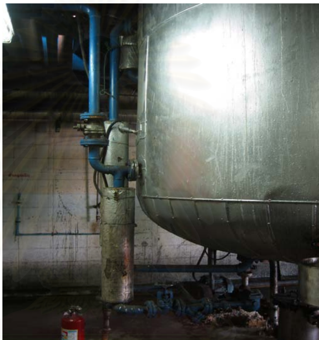
รูปที่ 6.6 ระบบการเก็บตัวอย่างเรซินเพื่อตรวจสอบคุณภาพหลังการปรับปรุง
