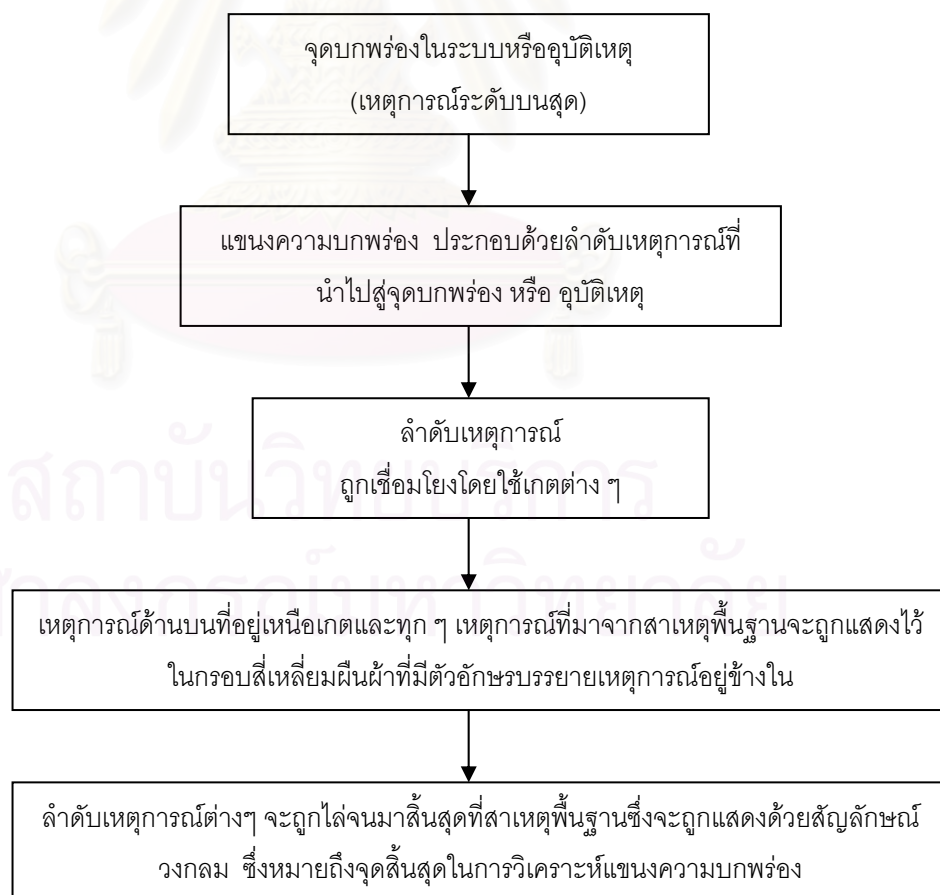
รูปที่ 2.4 โครงสร้างพื้นฐานในการวิเคราะห์แขนงความบกพร่อง
