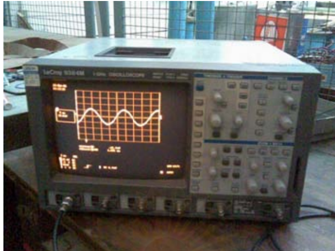
รูปที่ 3.21 เครื่องวัดสัญญาณดิจิทัลแบบ 4 ช่อง ยี่ห้อ LeCroy รุ่น 9384 M
