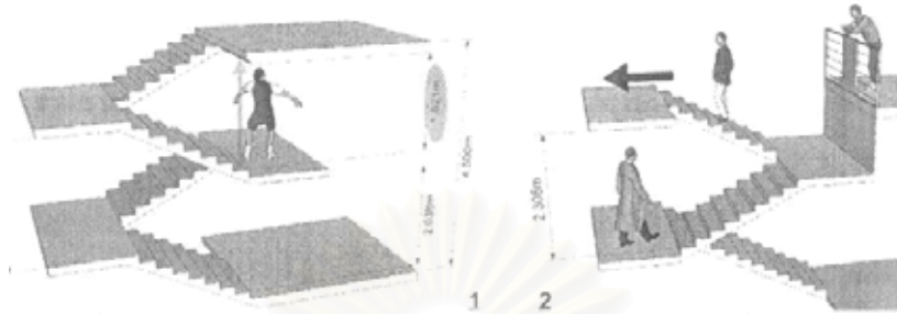
รูปที่ 2.9 ข้อสังเกตการกำหนดบันไดสำหรับความสูงช่วง 4-6 ม. ที่ทำได้ยาก
