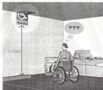
รูปที่ 2.10 ปัญหาที่เกิดจากการกำหนดป้ายที่ความสูงในอาคารจอดรถ
