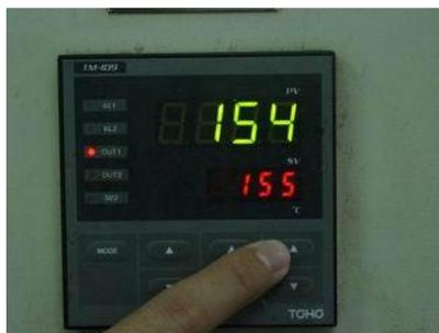
รูปที่ 11. กดลูกศรขึ้นในหลักหน่วยตัวเลขจะเพิ่มขึ้นทีละ 1
