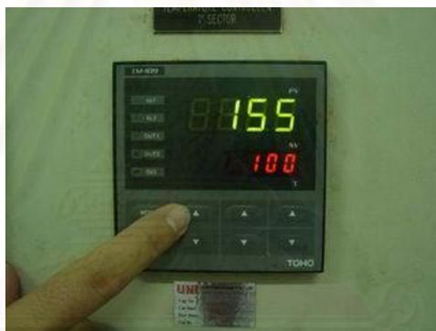
รูปที่ 9. กดลูกศรขึ้นในหลักร้อยตัวเลขจะเพิ่มขึ้นทีละ 100
