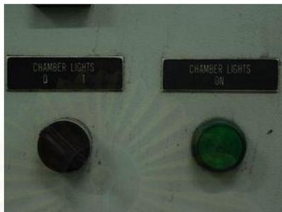
รูปที่ 15. สวิตช์ เปิด-ปิด หลอดไฟภายในเตา
