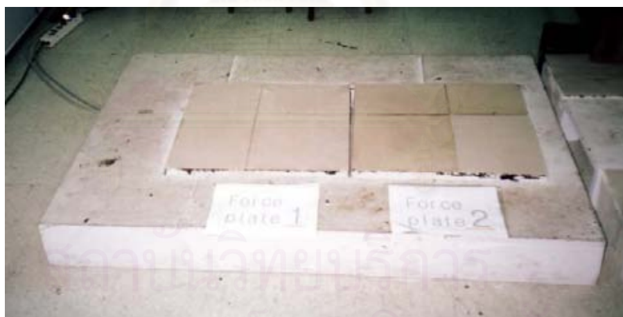
รูปที่ จ.2 แผ่นวัดแรงปฏิกิริยาที่พื้น จำนวน 2 แผ่นประกบกัน วางอยู่ใต้แผ่นปูน ที่ปูกระเบื้องทางด้านบน
