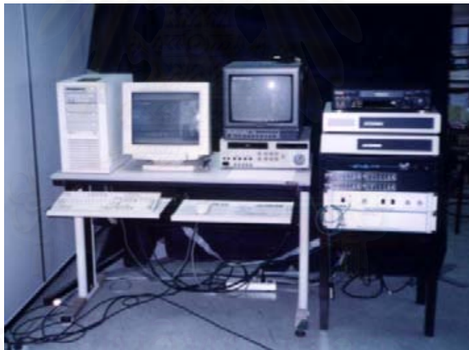
รูปที่ ๑.8 ชุดเครื่องวัดการเคลื่อนไหวของร่างกาย (Peak Motus System)
