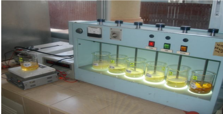
รูปที่ 4.17 การทดลองจาร์เทสต์เพื่อหาค่าพีเอชที่เหมาะสมของน้ำเสีย SC
