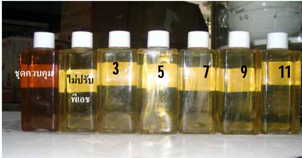
รูปที่ 4.5 ผลการทดลองในการลดสีของน้ำเสีย SC ที่ค่าพีเอชต่างๆ
