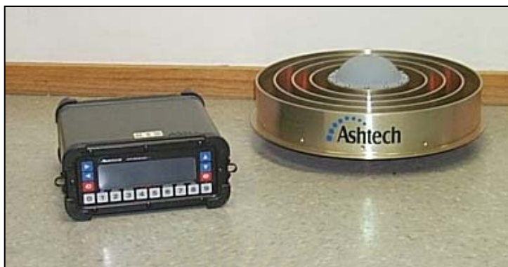
รูปที่ 1.3 เครื่องรับสัญญาณดาวเทียม Ashtech รุ่น Z-Xtreme และเสาอากาศ
