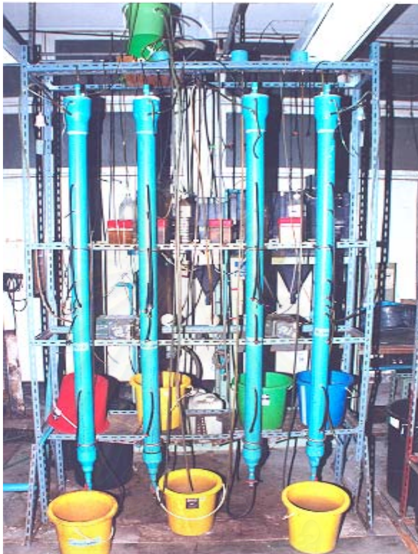
รูปที่ 4.1 การติดตั้งอุปกรณ์ของระบบถังแวนแอโรบิกไฮบริดยูเอเอสบี
