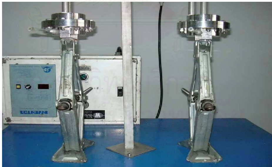
รูปที่ 4.6 แสดงโมดูลของเยื่อแผ่นนาโนฟิลเตรชัน
