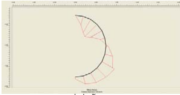
หน่วยแรงเฉือนที่เพิ่มขึ้นของโครงสร้างหลัก
