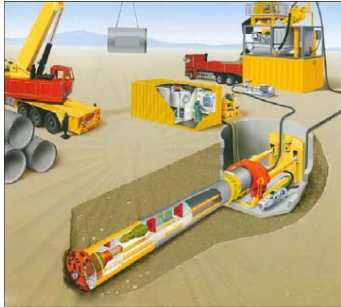
รูปที่ 2.16 ภาพรวมในการเจาะท่อตันลอด (Pipe Jacking Associate of Australasia, 1995) ส่วนประกอบของท่อตันลอดแสดงดังรูปที่ 2.17 มีดังต่อไปนี้
