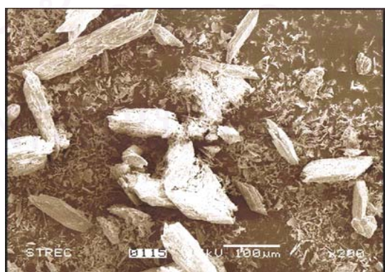
รูปที่ 4-35 ภาพถ่าย SEM ของส่วนไม่ติดแม่เหล็ก (Non-Magnetic Product) ของส่วนหยาบ (Underflow) ที่ผ่านการคัดขนาดด้วยไฮโดรไซโคลนที่ป้อนแร่ ที่ความเข้มข้น 5%
