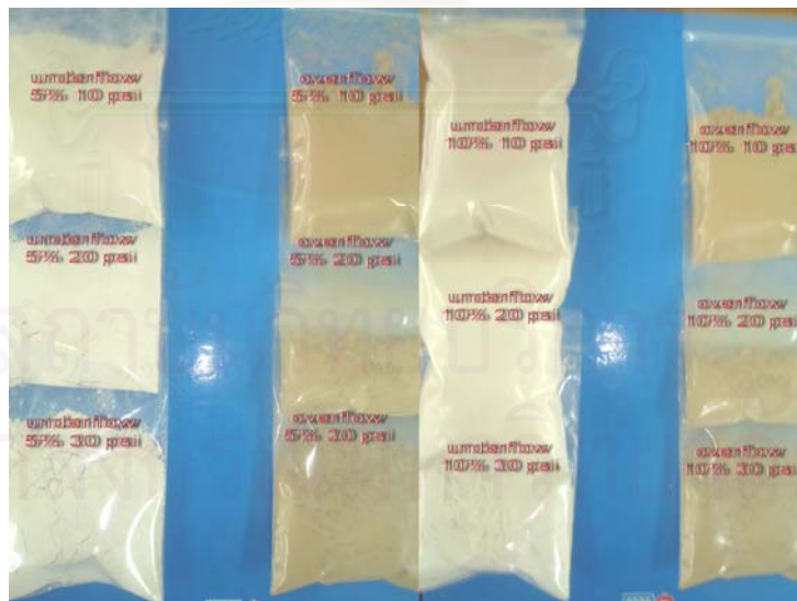
รูปที่ 4-9 ยิปซัมฟลูแก๊สที่ผ่านการคัดขนาดด้วยไฮโดรไซโคลนในส่วนหยาบ (Underflow) โดยการป้อนแร่ที่ 5% solid โดยน้ำหนักและ 10% solid โดยน้ำหนักที่ความดันที่ 10, 20 และ 30 ปอนด์ต่อตารางนิ้ว
