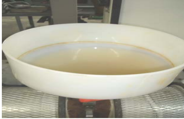
รูป 4-24 เครื่องป้อน (Feeding Device) ทำการป้อนแร่ยิปซัมที่ผ่านการคัดขนาด เข้าเครื่องแยกแม่เหล็กความเข้มสูงแบบเปียก
