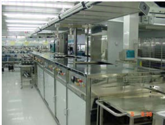
รูปที่ 4.1 ตัวอย่างเครื่องจักรกลุ่ม A (เครื่องทำความสะอาดผลิตภัณฑ์)
