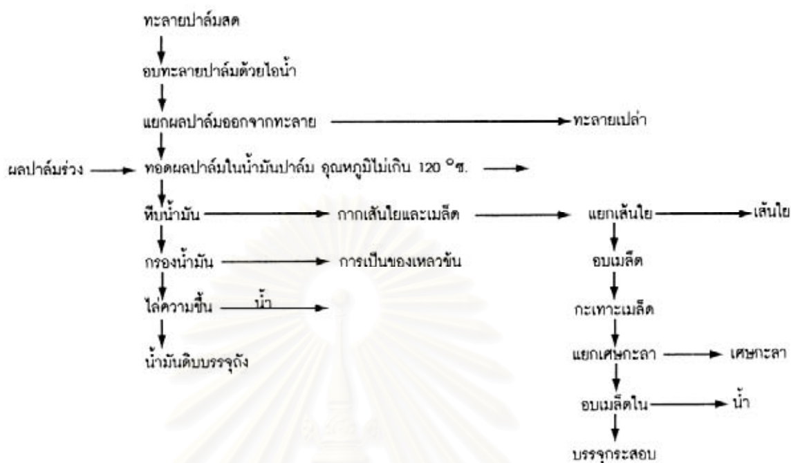
รูปที่ 2.6 ขั้นตอนการหีบน้ำมันแบบแยกเปลือกและเมล็ดในโดยไม่ใช้น้ำ (กรมส่งเสริมการเกษตร, 2547)
