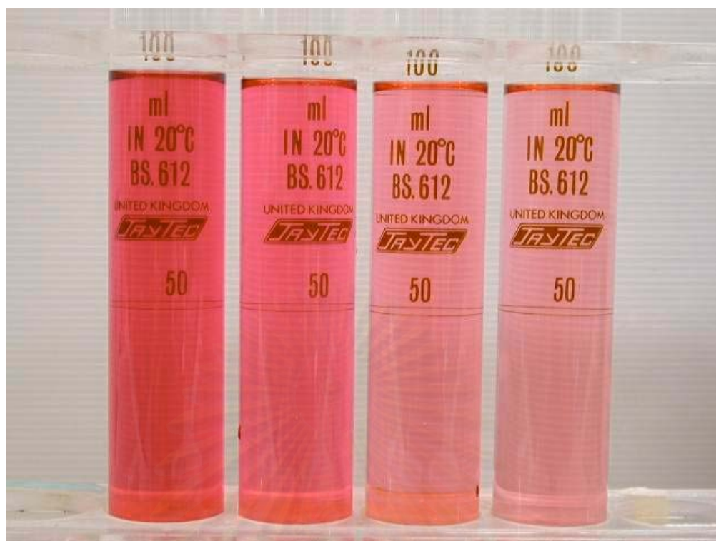
ก : น้ำเสียดิบ ข : 1 เท่า ค : 3 เท่า ง : 5 เท่า รูปที่ 4.89 ผลการทดลองหาปริมาณ SBH ที่เหมาะสมของสี C.I. Reactive Red 180 ความเข้มข้น 50 มิลลิกรัมต่อลิตร โดยมี พีเอช เริ่มต้นเท่ากับ 10
