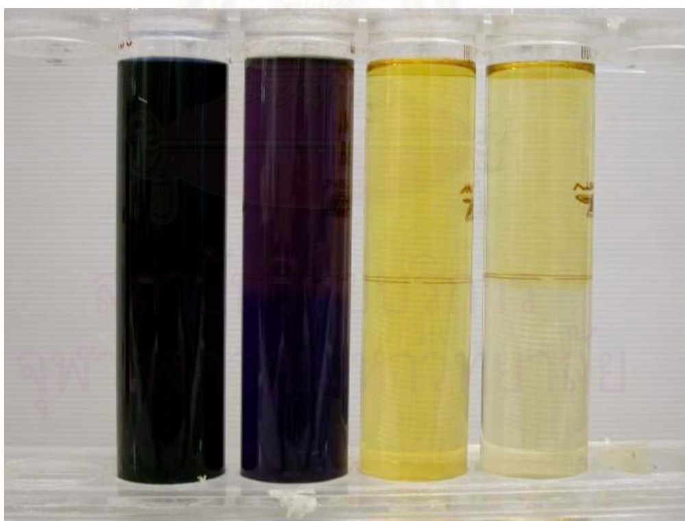
รูปที่ 4.79 ผลการทดลองหาปริมาณ SBH ที่เหมาะสมของสี C.I. Reactive Black 5 ความเข้มข้น 50 มิลลิกรัมต่อลิตร โดยมี พีเอช เริ่มต้นเท่ากับ 10
