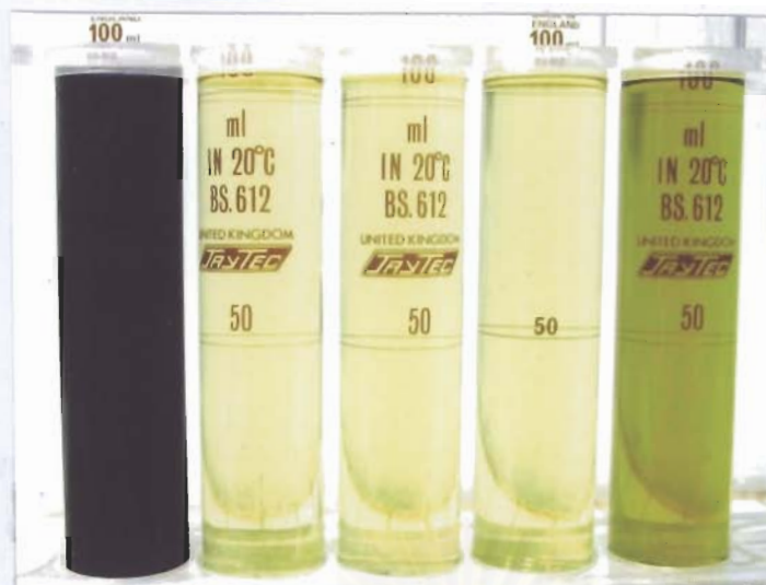
รูปที่ 4.109 ผลการทดลองแปรค่า SBH : \text{Na}_2\text{S}_2\text{O}_4 และเปรียบเทียบกับ \text{Na}_2\text{S}_2\text{O}_4 ของสี C.I. Reactive Black 5 ความเข้มข้น 200 มิลลิกรัมต่อลิตร ปริมาณ SBH 7 เท่า โดยมี pH เริ่มต้นเท่ากับ 10
