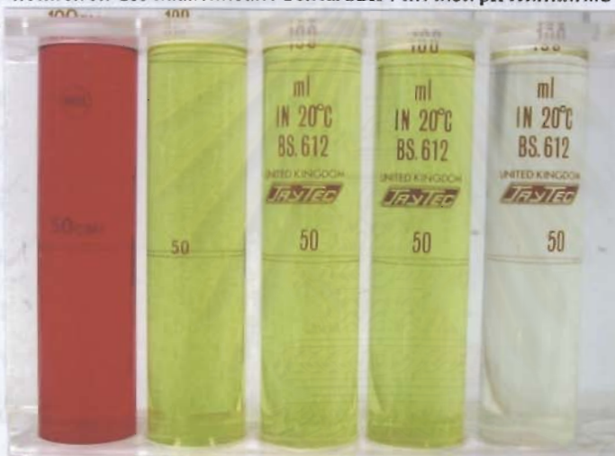
รูปที่ 4.109 ผลการทดลองแปรค่า SBH : \text{Na}_2\text{S}_2\text{O}_4 และเปรียบเทียบกับ \text{Na}_2\text{S}_2\text{O}_4 ของสี C.I. Reactive Black 5 ความเข้มข้น 200 มิลลิกรัมต่อลิตร ปริมาณ SBH 7 เท่า โดยมี pH เริ่มต้นเท่ากับ 10
