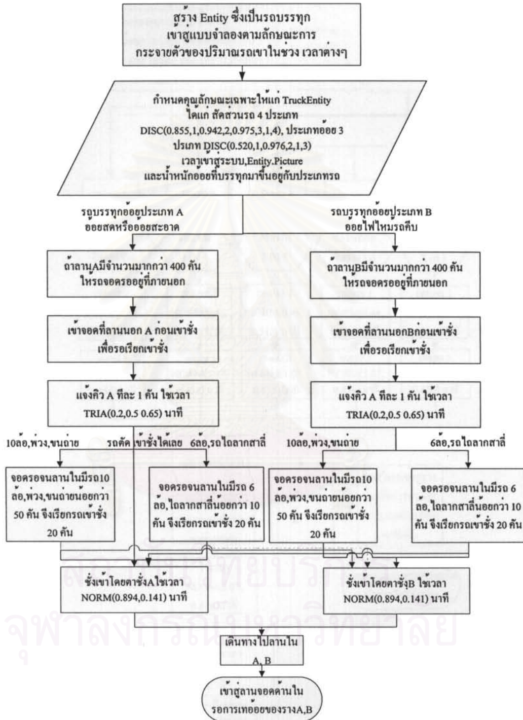
รูปที่ ๑. 1 โครงสร้างแบบจำลองของโรงงานน้ำตาล S25
