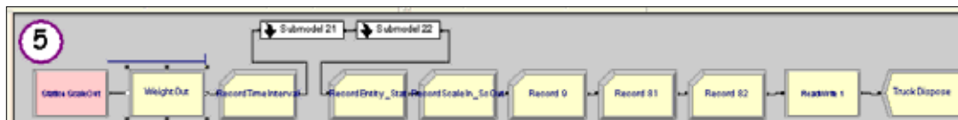
รูปที่ 5.10 แบบจำลองรถบรรทุกซึ่งนำหนักออกจากโรงงานและบันทึกค่าในระบบ
