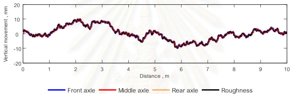
รูปที่ 3.17 แสดงการกระจัดของเพลลาต่างๆเปรียบเทียบกับลักษณะหน้าข้างของความขรุขระที่ตำแหน่งเดียวกัน
