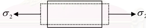
รูปที่ 3.2 การเปลี่ยนแปลงรูปปร่างของวัสดุเมื่อใส่เฉพาะค่า \sigma_2
