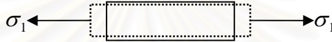
รูปที่ 3.1 การเปลี่ยนแปลงรูปปร่างของวัสดุเมื่อใส่เฉพาะค่า \sigma_1
