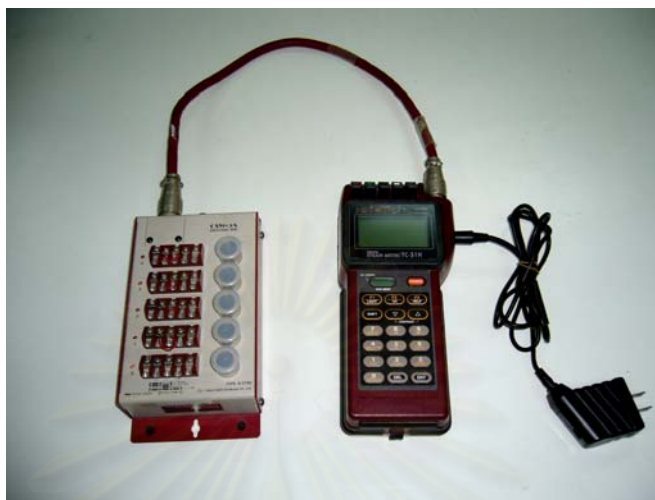
รูปที่ ก.5 Digital strain meter รุ่น TC-31K พร้อมชุดขยายสัญญาณ
