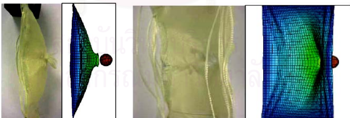
รูปที่ 2.5 ผลการจำลองเปรียบเทียบกับผลการทดลองซึ่งให้ค่าใกล้เคียงกัน (Lim et al. , 2003)
