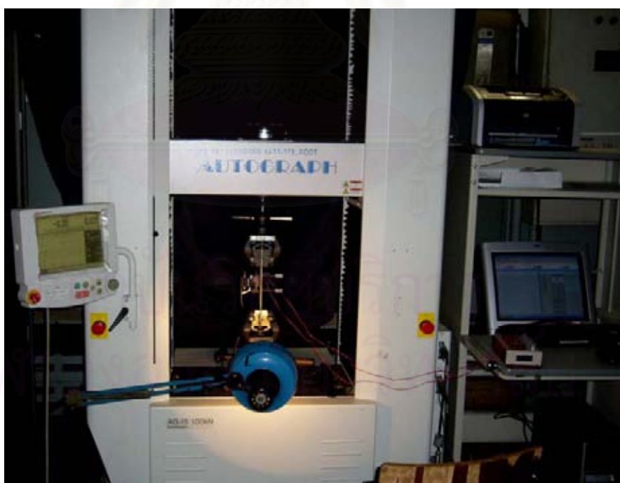
รูปที่ ก.8 การติดตั้งชิ้นงานทดสอบเข้ากับเครื่องทดสอบและเครื่องมือวัดต่างๆ ที่ติดตั้งเข้ากับชิ้นงาน
