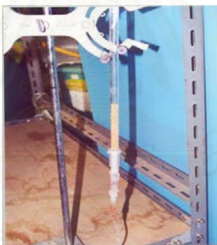
รูปที่ 4.24 ชุดอุปกรณ์ทดลองแบบคอลัมน์
