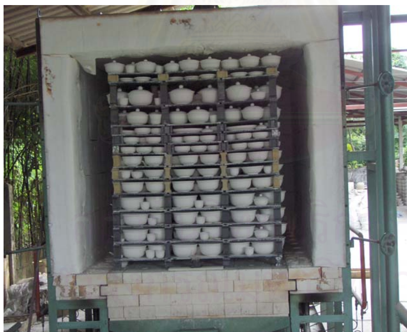
รูปที่ 4.3 การจัดเรียงชิ้นงานภายในเตาเผา
