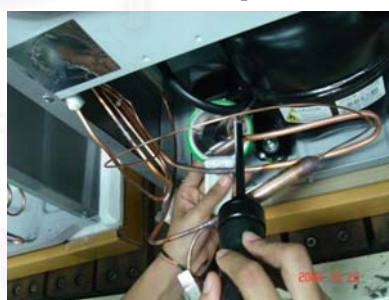
รูปที่ 3.4 แสดงการตรวจสอบการรั่วไหลของก๊าซ He ด้วยเครื่องตรวจจับก๊าซ
