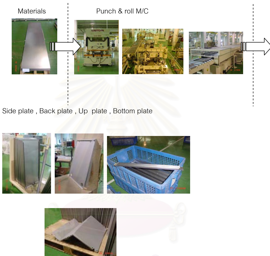
รูปที่ 1.4 แสดงกระบวนการผลิตของหน่วย Metal forming
