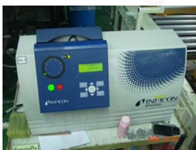
รูปที่ 3.4 แสดงการตรวจสอบการรั่วไหลของก๊าซ He ด้วยเครื่องตรวจจับก๊าซ
