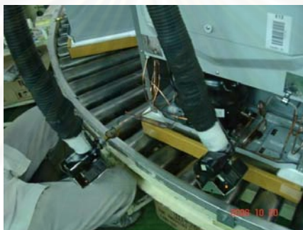
รูปที่ 3.3 แสดงการ Charge He เพื่อทดสอบการรั่วไหลของก๊าซ
