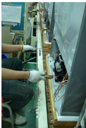
รูปที่ 3.2 แสดงการสวม Pipe coupler เข้าที่ท่อทองแดง
