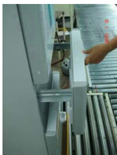
รูปที่ 3.14 แสดงลักษณะปัญหาประตู Slide ฝืด
