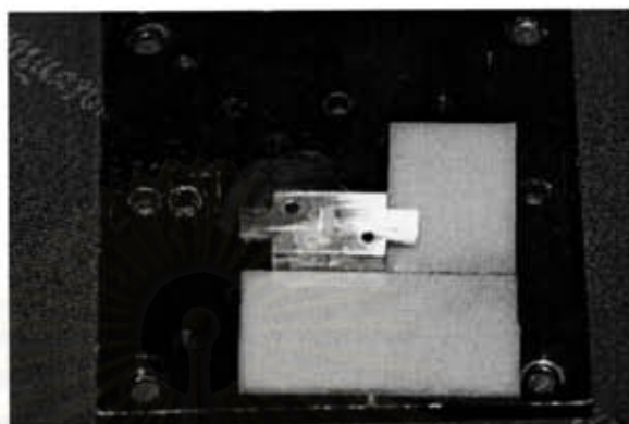
ภาพที่ 13 แสดงการยึดชิ้นตัวอย่างกับฐานของเครื่องวัดความหนาผิว
