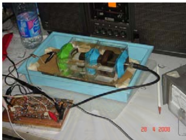
รูปที่ 4.6 การทดลองส่งและรับสัญญาณอัลตราโซนิกแบบแยกตัวรับ-ส่ง
