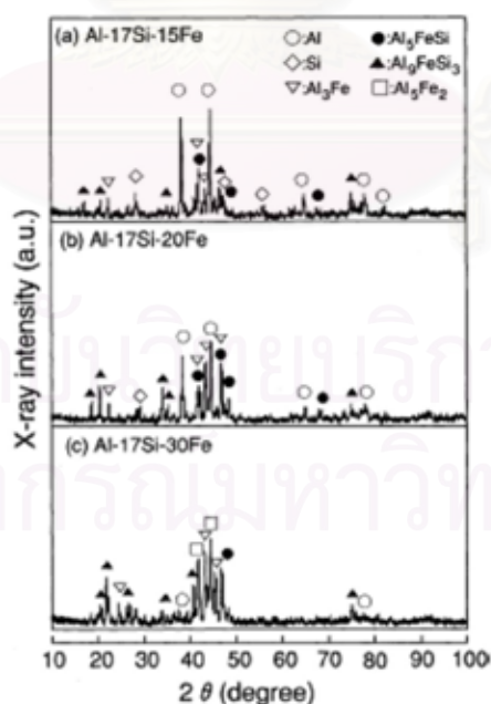
รูปที่ 2.2 X-ray diffraction ของ ชั้นเคลือบ [3]
