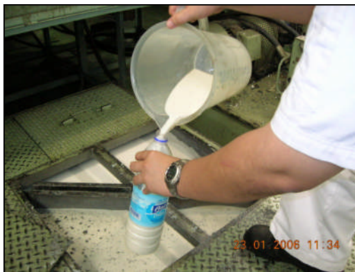
รูปที่ 4.1 วิธีเก็บตัวอย่างน้ำมันหล่อเย็นที่ผ่านการใช้งานแล้ว
