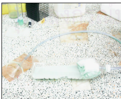
รูปที่ 5.6 ถังโคเอเลสเซอร์ทำจากขวดน้ำ 1.5 ลิตร
