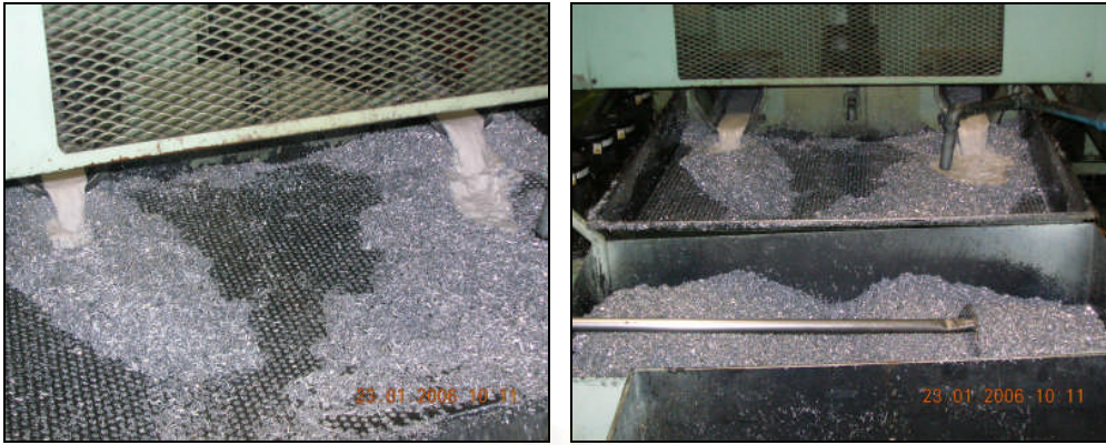
รูปที่ 3.3 ตะแกรงแยกเศษโลหะภายในถังพัก
