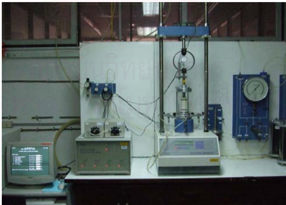
ภาพที่ 3.5 ภาพเครื่องมือทดสอบแรงอัดสามแกน อุปกรณ์บันทึกผลและอุปกรณ์วัดค่าต่างๆ
