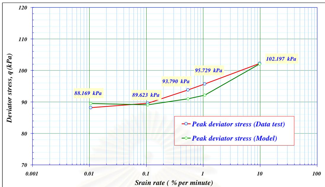
ภาพที่ 4.21 แสดงการเปรียบเทียบค่าหน่วยแรงเบี่ยงเบนสูงสุดของผลการทดสอบกับแบบจำลองที่ระดับความเครียดเดียวกัน ที่ให้ค่าหน่วยแรงเบี่ยงเบนสูงสุด
