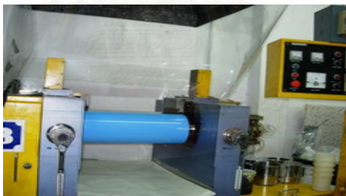
รูปที่ 2.13 เครื่องผสมแบบ 2 ลูกกลิ้ง (two-roll mill)
