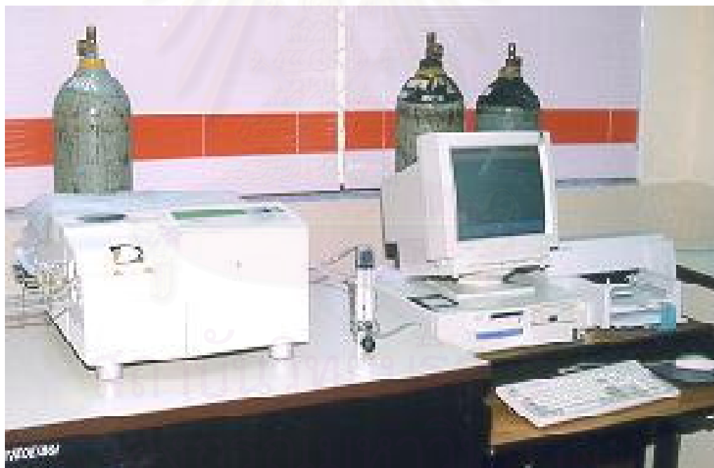
รูปที่ 3.6 เครื่อง TGA ของ METTLER TOLEDO รุ่น TGA/SDTA 851 e
