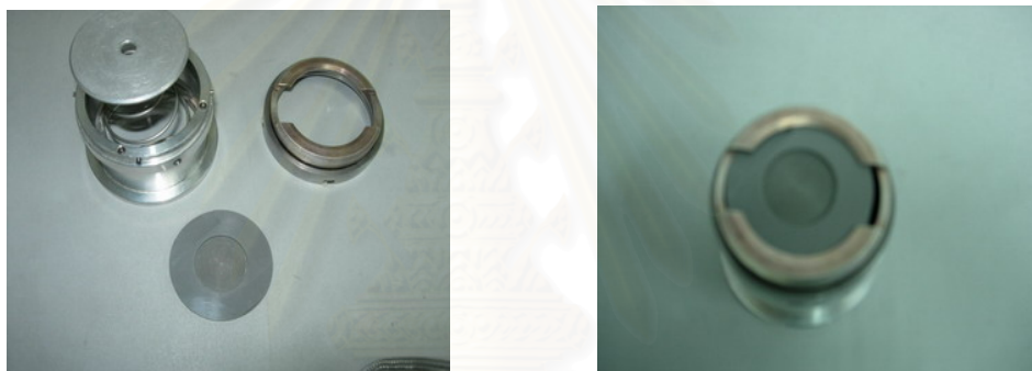
รูปที่ 3.2 ส่วนประกอบและลักษณะของแผ่นที่ยึดตัวอย่าง (sample holder)
