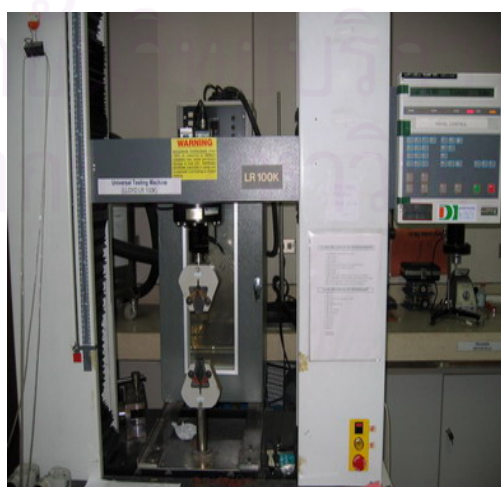
รูปที่ 3.4 เครื่อง universal testing machine ของ LLOYD รุ่น LR 100K plus
