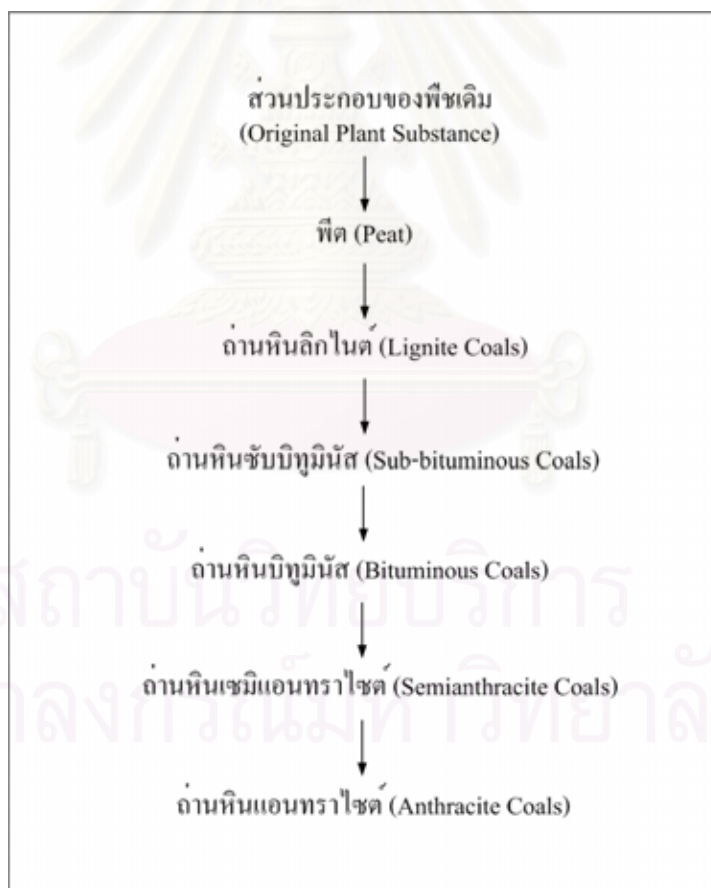
รูปที่ 2.1 แสดงการเปลี่ยนแปลงการเกิดของถ่านหิน [1]
