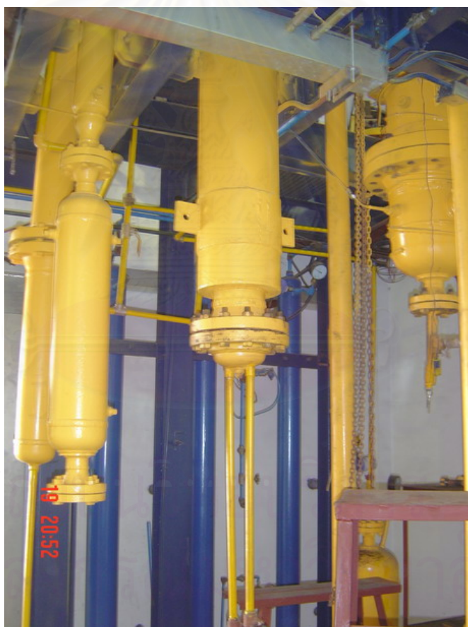
รูปที่ 3.12 อุปกรณ์ลดอุณหภูมิก๊าซผลิตภัณฑ์ (Coal Gas Cooler)
