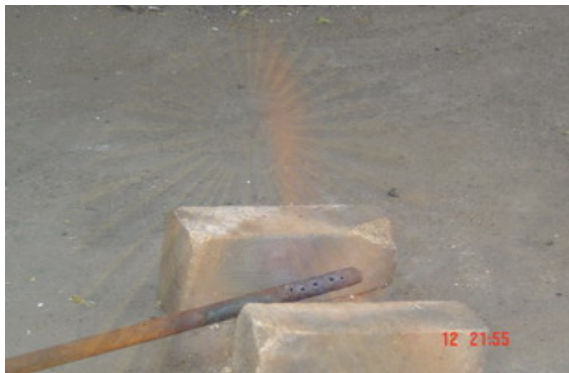
รูปที่ 3.19 หัวเผาและเปลวไฟจากการเผาไหม้ก๊าซผลิตภัณฑ์
