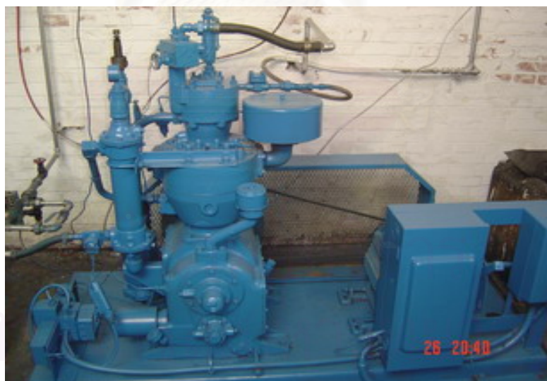
รูปที่ 3.4 เครื่องอัดอากาศ (Air Compressor)
