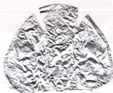
รูปที่ 26 แสดงตัวอย่างของแผ่นอลูมิเนียมฟอยด์ที่แผ่ให้แบนและใช้ในการหาขนาดพื้นที่
