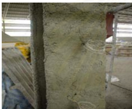
รูปที่ ช-5 แสดงการหยุดพ่นแล้วทิ้งไว้เพื่อป้องกันการเยิ้มของวัสดุผสมเพอร์ไลต์เปียกแล้วทำการวัดความหนา การเตรียมชิ้นตัวอย่างและการทดสอบการรับน้ำหนัก
