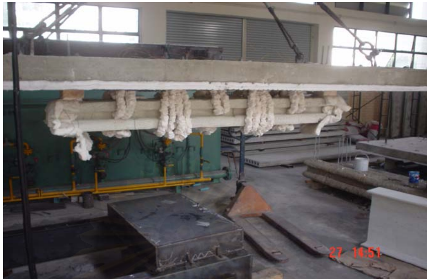
รูปที่ 3-8 ชิ้นตัวอย่างที่ทำการปิดหัวและท้ายด้วยเซรามิกไฟเบอร์แล้วติดตั้งบนฝาเตาเผา
