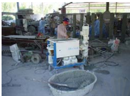
รูปที่ ช-4 แสดงการผสมวัสดุผสมเพอร์ไลต์แห้งกับน้ำในกะบะผสมเพื่อคลุกให้เข้ากันก่อนนำลงเครื่องพ่น และนำส่วนผสมใส่ลงในเครื่องพ่น
