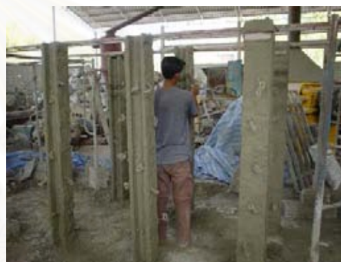
รูปที่ ช-5 แสดงการหยุดพ่นแล้วทิ้งไว้เพื่อป้องกันการเยิ้มของวัสดุผสมเพอร์ไลต์เปียกแล้วทำการวัดความหนา การเตรียมชิ้นตัวอย่างและการทดสอบการรับน้ำหนัก
