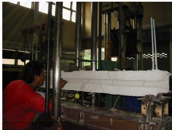
รูปที่ ช-8 แสดงการตรวจสอบหารอยแตกร้าวที่เกิดขึ้นบนตัวอย่างก่อนการทดสอบ
