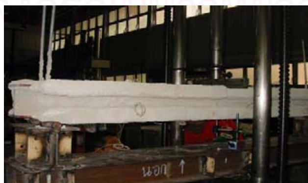
รูปที่ ช-6 แสดงการติดตั้งตัวอย่างบนเครื่องทดสอบการรับน้ำหนัก
