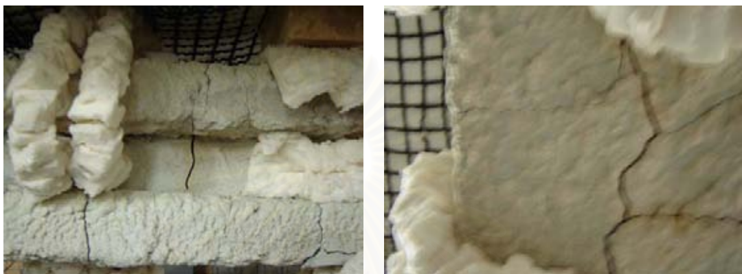
รูปที่ ช-12 แสดงชิ้นตัวอย่างภายหลังการทดสอบการทนไฟ
