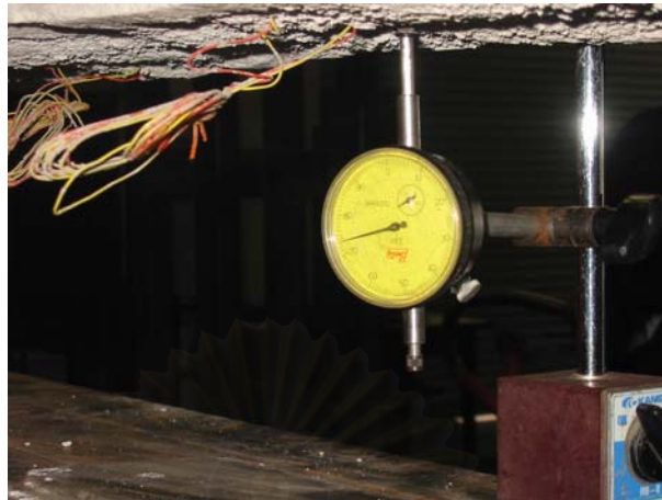
รูปที่ ช-7 แสดงการติดตั้งเครื่องมือการวัดค่าการแอ่นตัวในแนวตั้งบนตัวอย่างก่อนการทดสอบ
