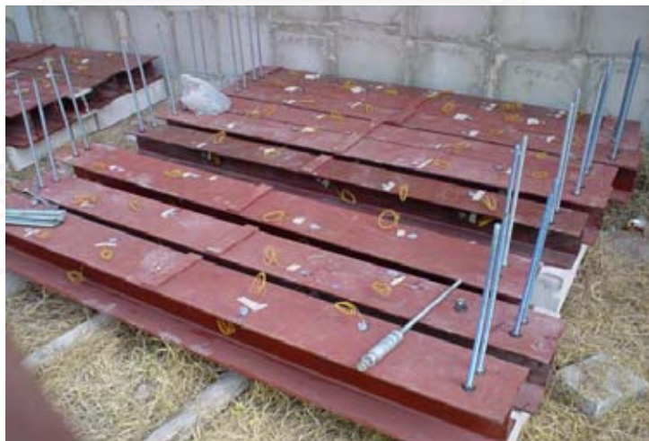
รูปที่ ข-1 แสดงคานเหล็กรูปพรรณที่ทาสี เจาะรูพร้อมติดตั้งเหล็กตัดและเชื่อมสายวัดอุณหภูมิเรียบร้อยแล้ว
