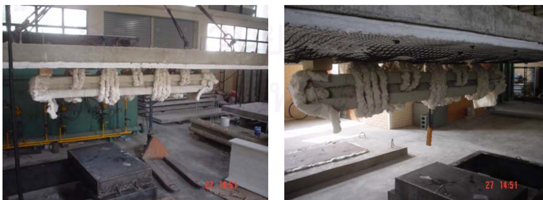
รูปที่ ข-11 แสดงชิ้นตัวอย่างที่ถูกติดตั้งบนฝาคอนกรีตเสริมเหล็กเพื่อนำไปวางบนเตาเผา
