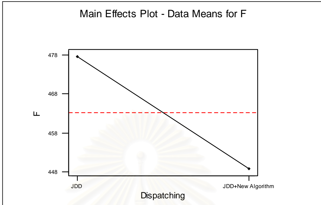
รูปที่ 6-26 เปรียบเทียบผลของเทคนิคในการลดลำดับความสำคัญที่มีต่อค่าเวลาการไหลของงานโดยเฉลี่ย ที่เกิดจากกฎ JDD-JIS ในระบบที่ผลิตชิ้นงาน โครงสร้างซับซ้อน (Complex Structure)
