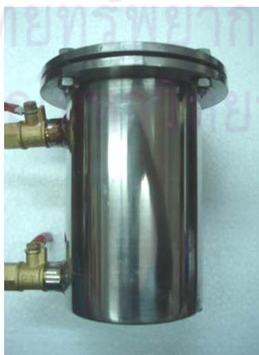
รูปที่ 3.1 ระบบทดลองที่ใช้วางภาชนะบรรจุน้ำทะเลเพื่อทำการฉายรังสี
