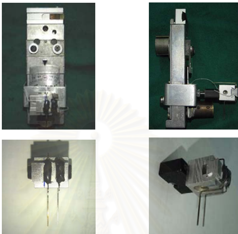
รูปที่ 20 เครื่องมือยึดแท่งพลาสติกและกลไกสำหรับกำหนดการยืดแบร็กเกต ให้ได้ตำแหน่งเดิมพร้อมทั้งปรับตั้งมุมของแบร็กเกต
