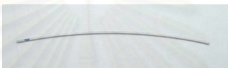
รูปที่ 18 ตัวอย่างลวดนิกลีไทเทเนียมเซนต์ลลอย ซึ่งเป็นลวดที่มีความโค้งก่อนทำการทดลอง
