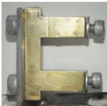
รูปที่ 17 เครื่องมือสำหรับยึดลวดให้อยู่กับที่
