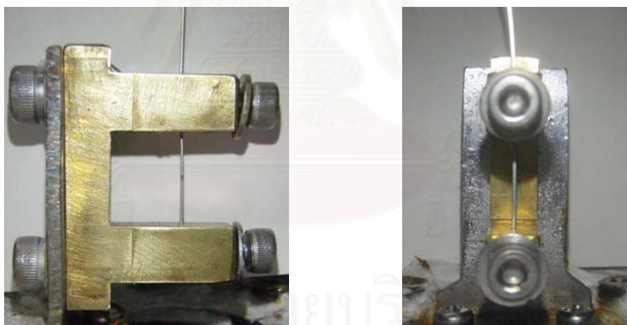
รูปที่ 19 ลวดนิกลีไทเทเนียมเซนต์ลลอยที่มีลักษณะเป็นเส้นตรง ในส่วนที่ถูกยึดอยู่ระหว่างแท่งโลหะรูปตัวซี
