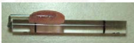
รูปที่ 16 เครื่องมือสำหรับกำหนดการยึดแบร็กเกตบน แท่งพลาสติกให้ได้ตำแหน่งเดิมทุกครั้ง
