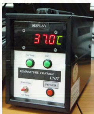
รูปที่ 23 วงจรควบคุมอุณหภูมิที่มีหน้าจอบ่งแสดงอุณหภูมิขณะทำการทดลอง
