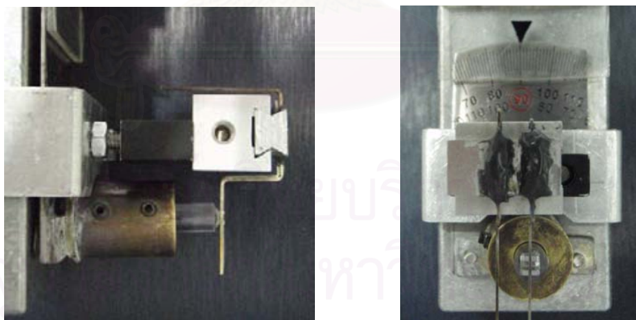
รูปที่ 21 ลักษณะของแบร็กเกตบนแท่งพลาสติกที่ทำมุม 0 องศา กับแนวตั้ง โดยใช้ เครื่องกำหนดการยืดแบร็กเกตและปรับตั้งมุม
