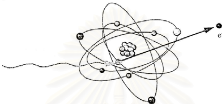
รูปที่ 2.10 การเกิดปรากฏการณ์โฟโตอิเล็กทริกเอฟเฟกต์
