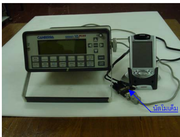
รูปที่ 3.2 ภาพการส่งผ่านข้อมูลผ่านสายโมเด็ม
